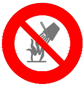
PROHIBIT APAGAR AMB AIGUA
