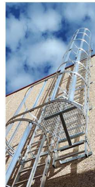
Plataforma intermedia para tramos mayores a 9m
