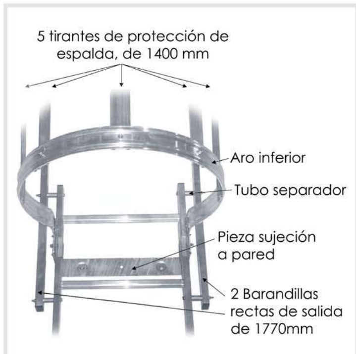
Unión tramo recto de escalera a barandilla recta de salida
