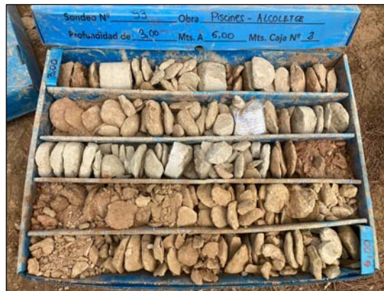
Fotografia 7. Vista dels materials recuperats en el sondeig S-3, en els trams de substrat Oligocè.
