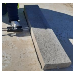
Figura 7. Ensayo para la determinación del coeficiente de fricción estático.
