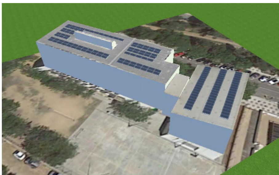
Il·lustració 5. Visualització 3D del camp fotovoltaic
