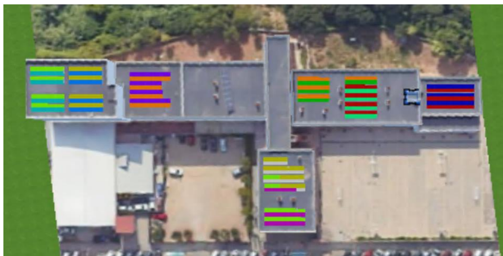
Figura 7 Distribució de panells/strings. Font: Infraestructures.cat
