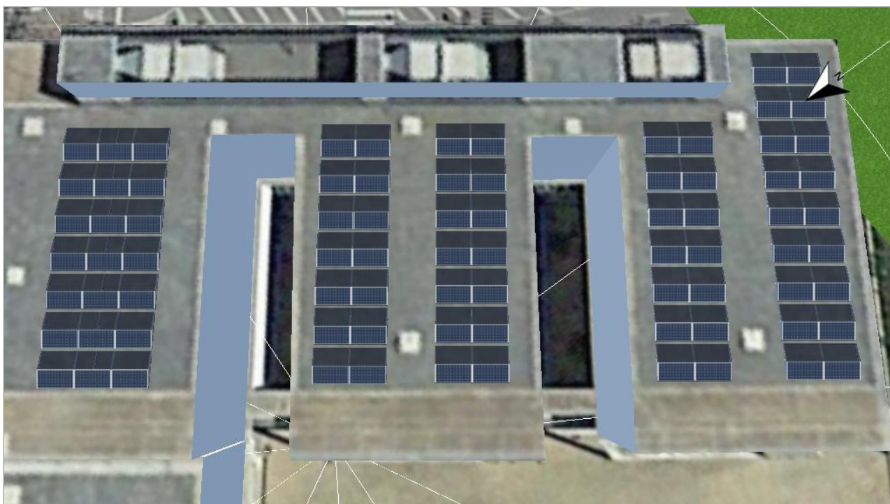
Figura: 4. Superficie fotovoltaica - Coberta Aulari-Superficie fotovoltaica Noroeste
