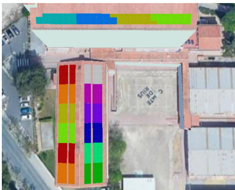
Figura 8 Disposició de strings d'instal·lació fotovoltaica. Font: Infraestructures.cat
