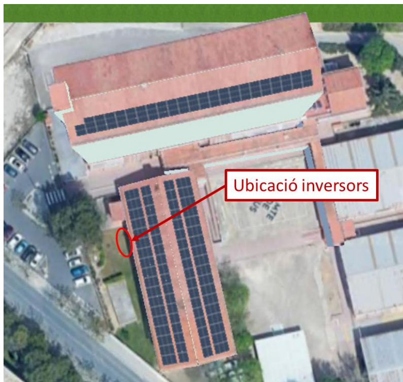
Figura 6 Ubicació prevista per instal·lació d'inversors. Font: Infraestructures.cat
