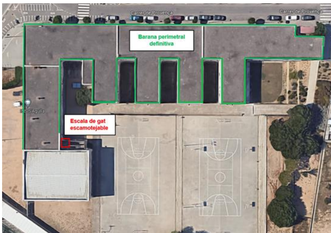
Il·lustració 16. Proteccions col·lectives i accessos durant la fase d'execució
