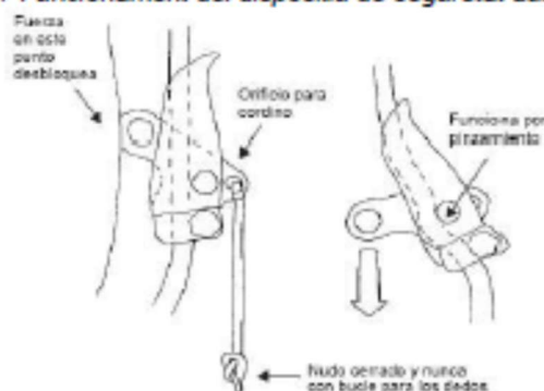
Figura 7 Funcionament del dispositiu de seguretat autoblocant
