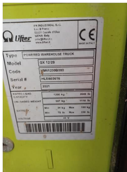
Elevador elèctric POWERED WATERHOUSE TRUCK Model GX12/29 1200Kg de l'any 2021
