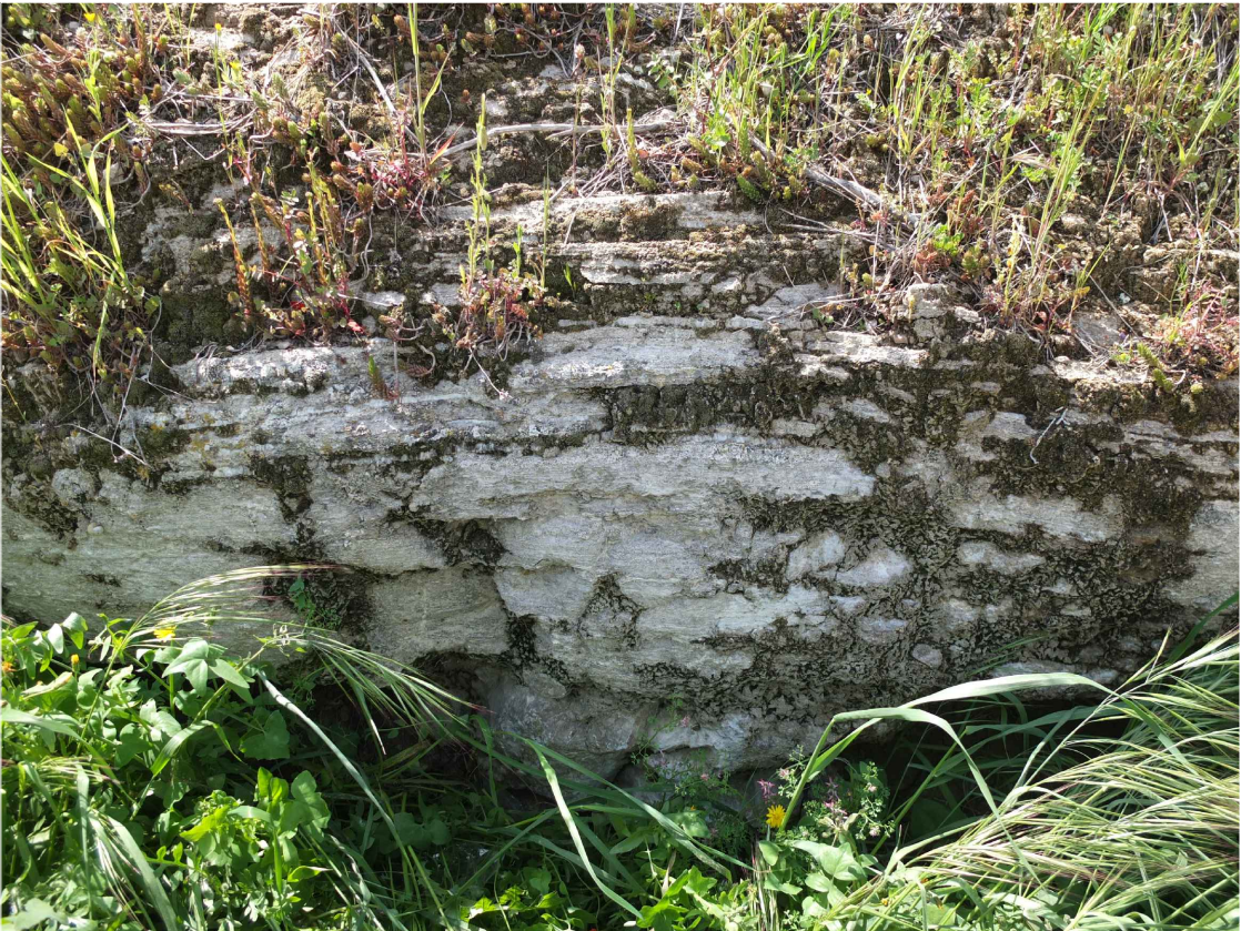
V4. Degradació per dissolució del guix granular dels estrats rocosos. Font: GAA 19/04/2018
