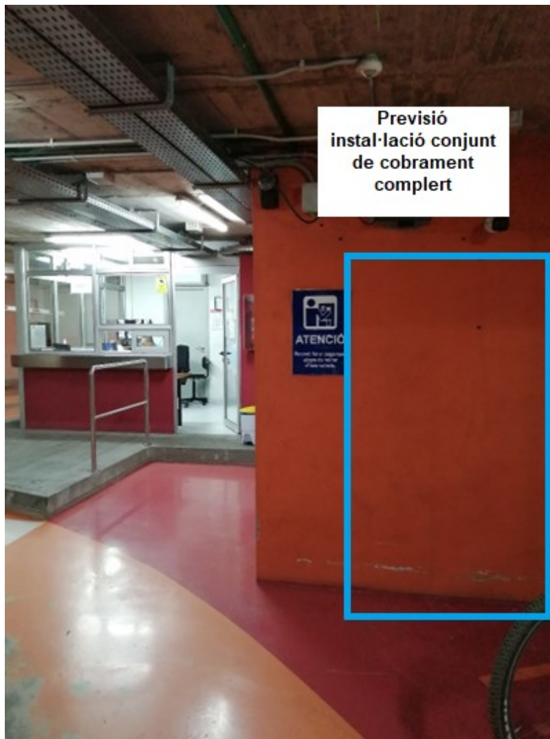
Imatge 9: Vista de la previsió d'instal·lació del conjunt de cobrament complert. Es preveu ancoratge directe del conjunt de cobrament complert al paviment.
