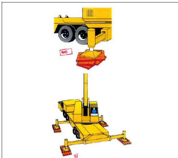
Col·locació estabilitzadors recolzaments
