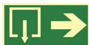
Figura 3. Pictograma per senyalitzar els trams dels recorreguts d'evacuació fins a sortides habituals o d'emergència d'acord norma UNE 23034:1998
