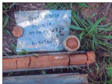
Foto 6: Sondeig S-2, SPT a 2,2 metres.
