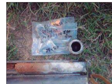
Foto 8: Sondeig S-2, SPT a 8,6 metres.
