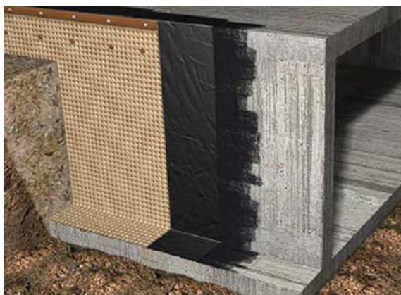
Imatge impermeabilització murs existents abans del reblert de terres
