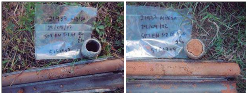
Assaig SPT realitzat a la capa A.
