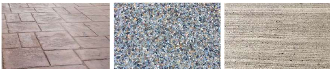
Diferents acabats del formigó (d'esquerra a dreta: imprès, rentat, ratllat o escombrat)
