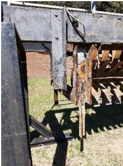
Il·lustració 2: Imatges de l'estat de les estructures dels rotors, totalment oxidats i en mal estat.
