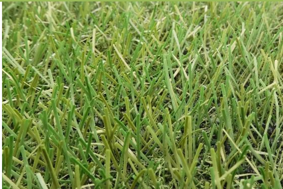
Fig. 32: FieldTurf RGF XM7 después de 300.000 ciclos Lisport
