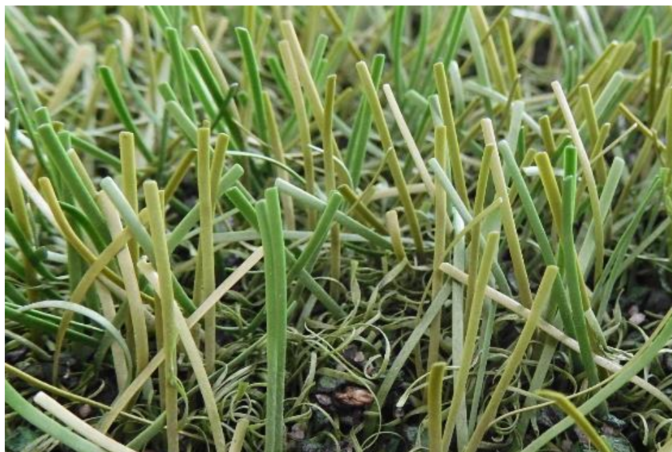
Fig. 19: FieldTurf RGF XM7 después de 160.000 ciclos Lisport
