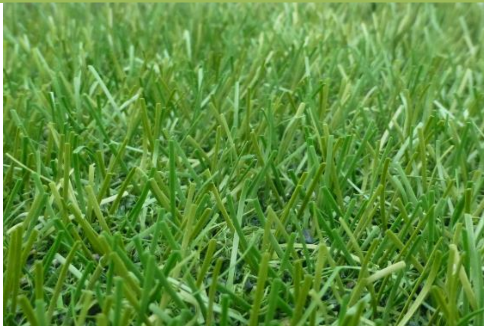
Fig. 18: FieldTurf RGF XM7 después de 140.000 ciclos Lisport
