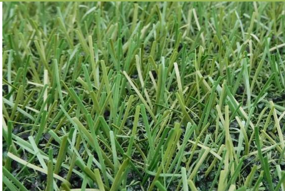
Fig. 26: FieldTurf RGF XM7 después de 240.000 ciclos Lisport
