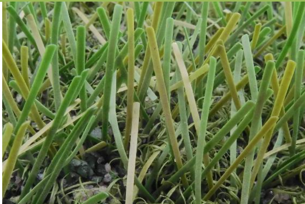
Fig. 40: FieldTurf RGF XM7 después de 350.000 ciclos Lisport
