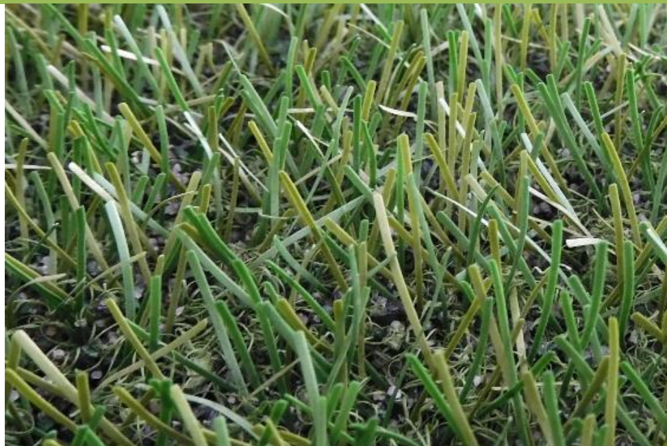
Fig. 38: FieldTurf RGF XM7 después de 350.000 ciclos Lisport
