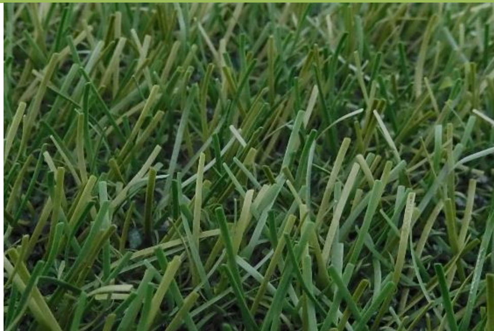
Fig. 14: FieldTurf RGF XM7 después de 120.000 ciclos Lisport
