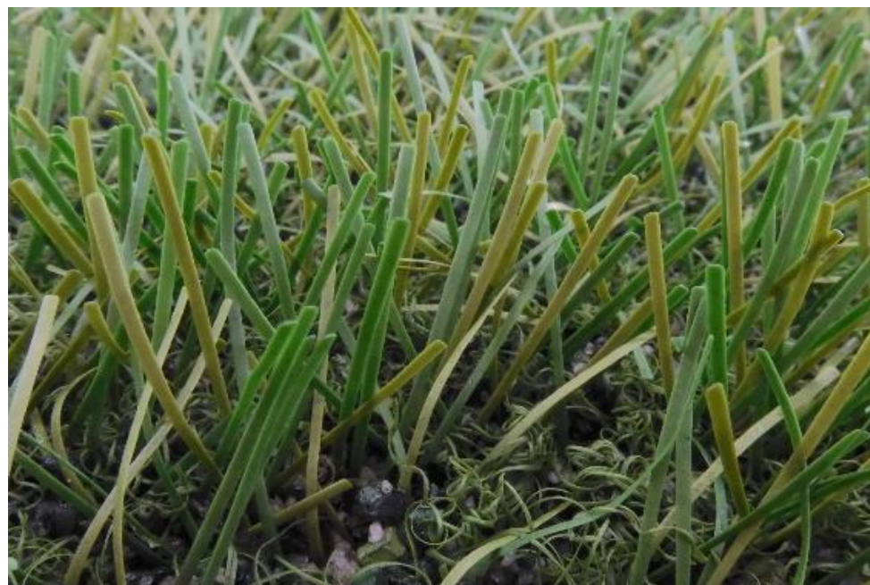
Fig. 41: FieldTurf RGF XM7 después de 350.000 ciclos Lisport
