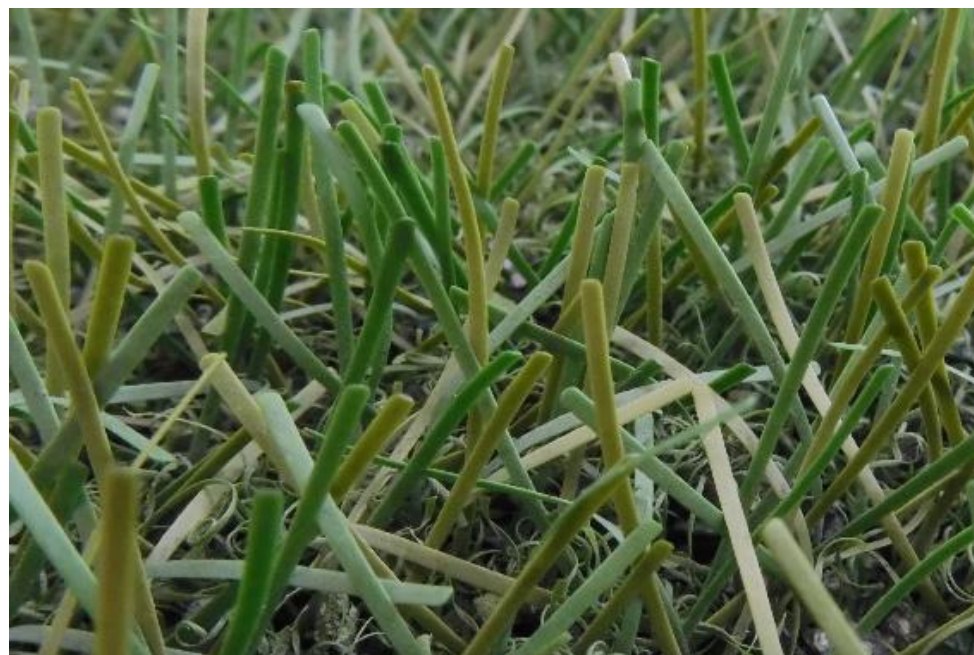
Fig. 37: FieldTurf RGF XM7 después de 340.000 ciclos Lisport
