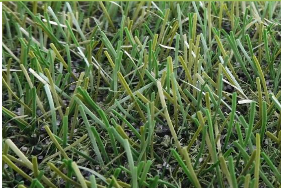
Fig. 38: FieldTurf RGF XM7 después de 350.000 ciclos Lisport
