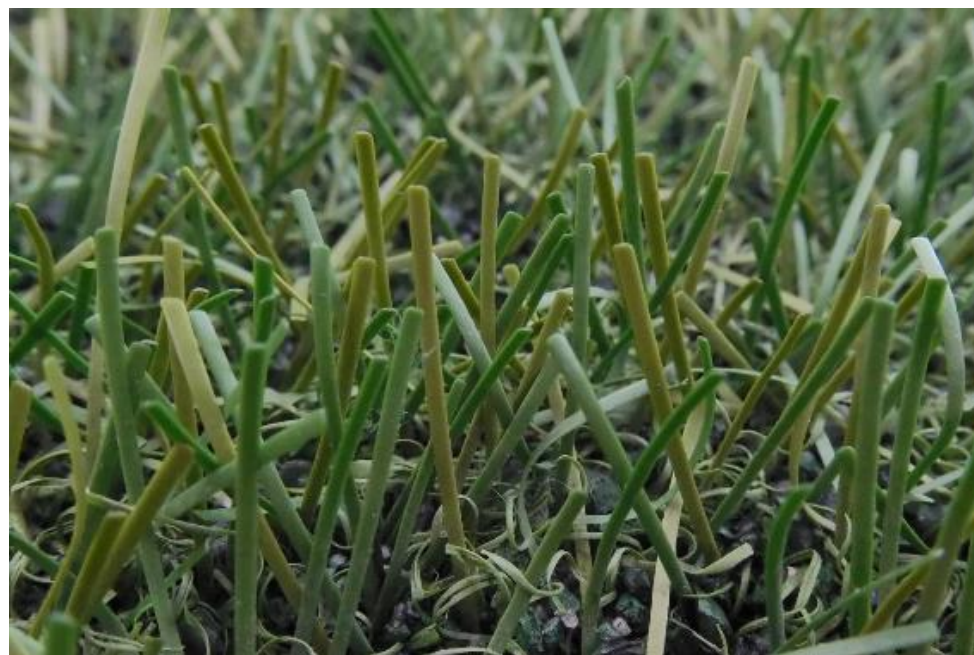
Fig. 21: FieldTurf RGF XM7 después de 180.000 ciclos Lisport
