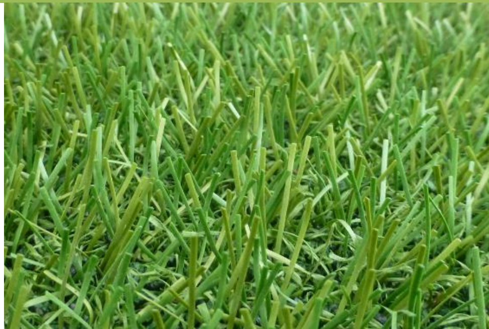
Fig. 8: FieldTurf RGF XM7 después de 60.000 ciclos Lisport
