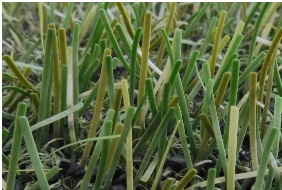
Fig. 35: FieldTurf RGF XM7 después de 320.000 ciclos Lisport
