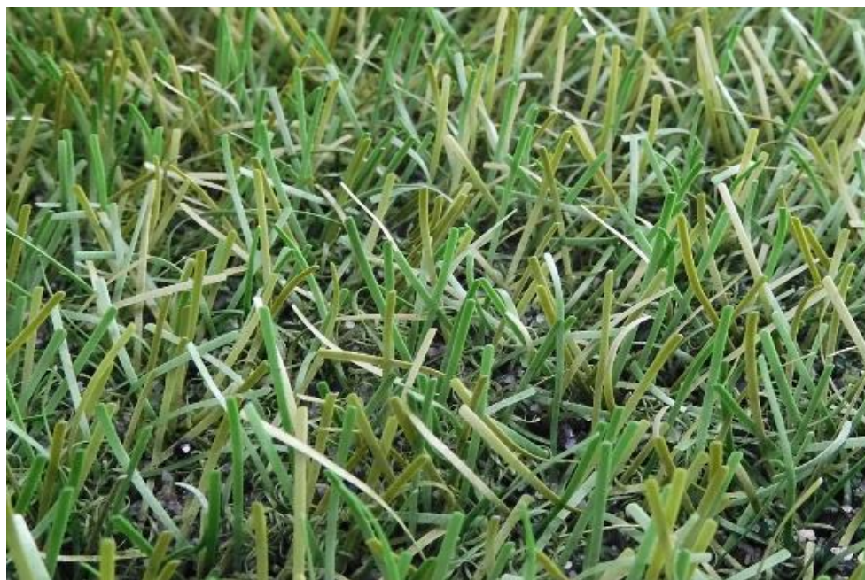
Fig. 39: FieldTurf RGF XM7 después de 350.000 ciclos Lisport
