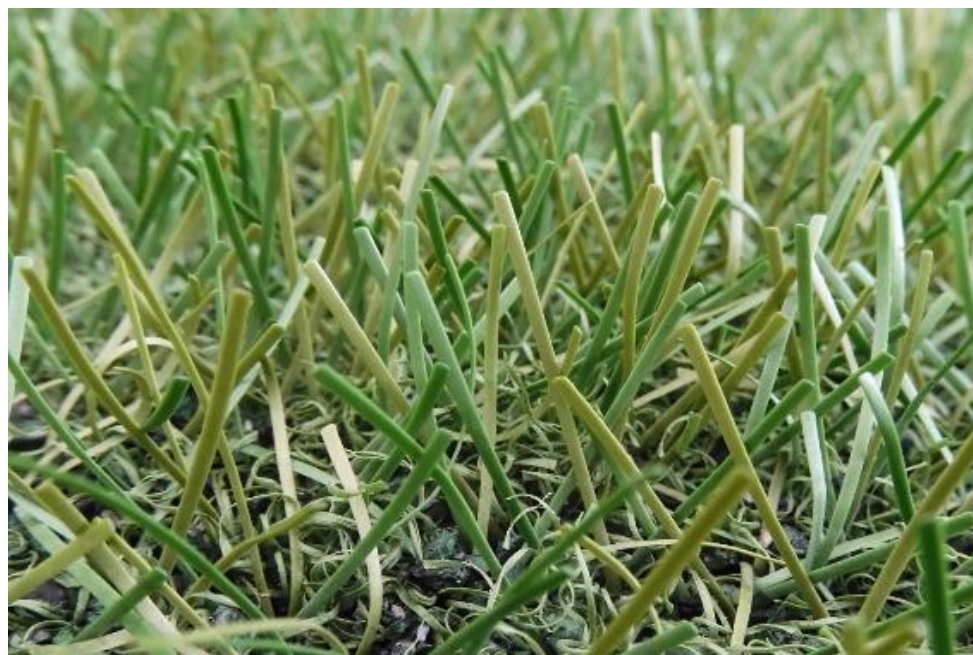
Fig. 23: FieldTurf RGF XM7 después de 200.000 ciclos Lisport
