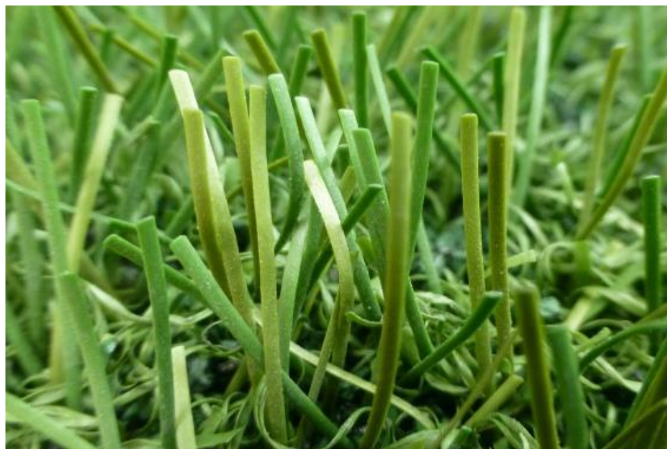
Fig. 9: FieldTurf RGF XM7 después de 60.000 ciclos Lisport
