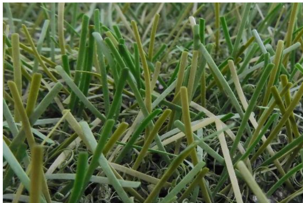
Fig. 37: FieldTurf RGF XM7 después de 340.000 ciclos Lisport
