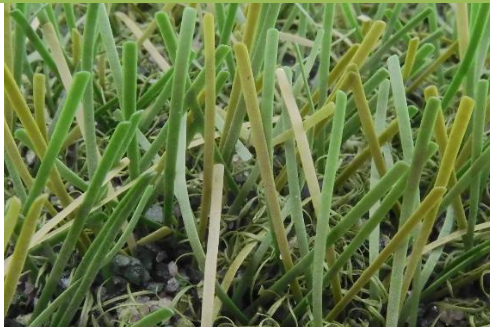
Fig. 40: FieldTurf RGF XM7 después de 350.000 ciclos Lisport
