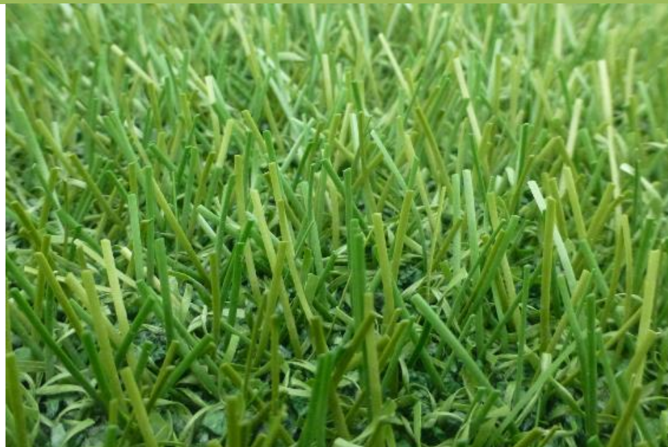
Fig. 4: FieldTurf RGF XM7 después de 20.000 ciclos Lisport
