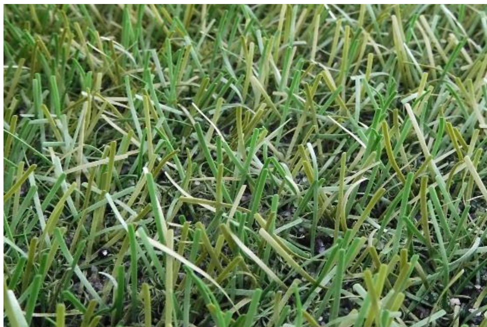
Fig. 39: FieldTurf RGF XM7 después de 350.000 ciclos Lisport
