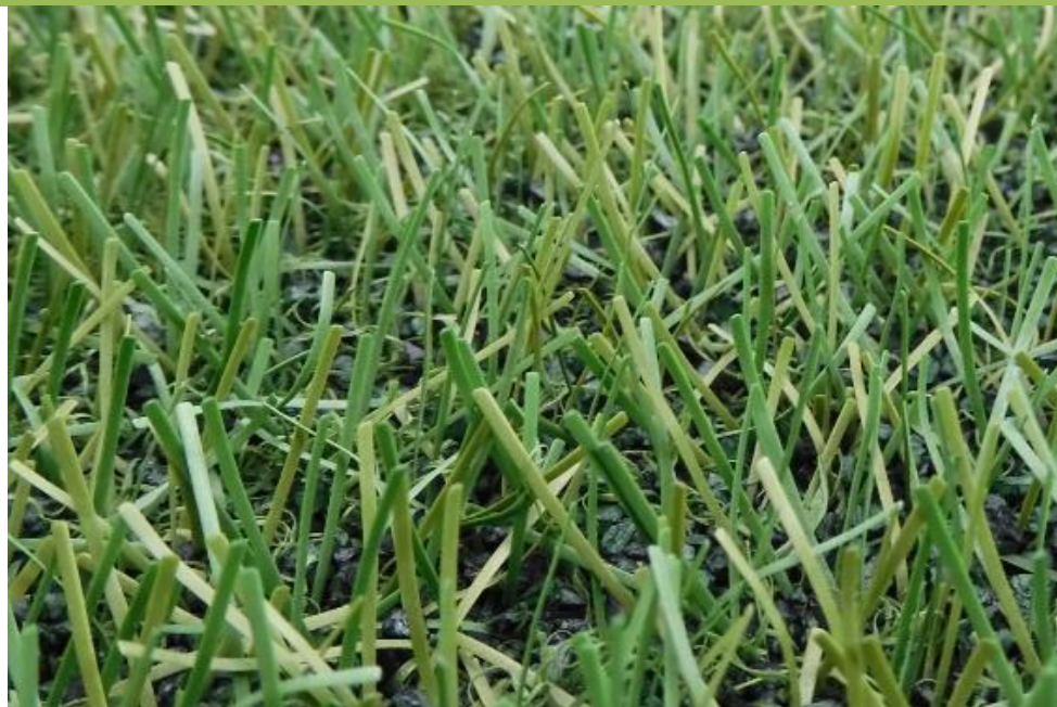
Fig. 24: FieldTurf RGF XM7 después de 220.000 ciclos Lisport
