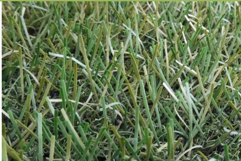
Fig. 36: FieldTurf RGF XM7 después de 340.000 ciclos Lisport
