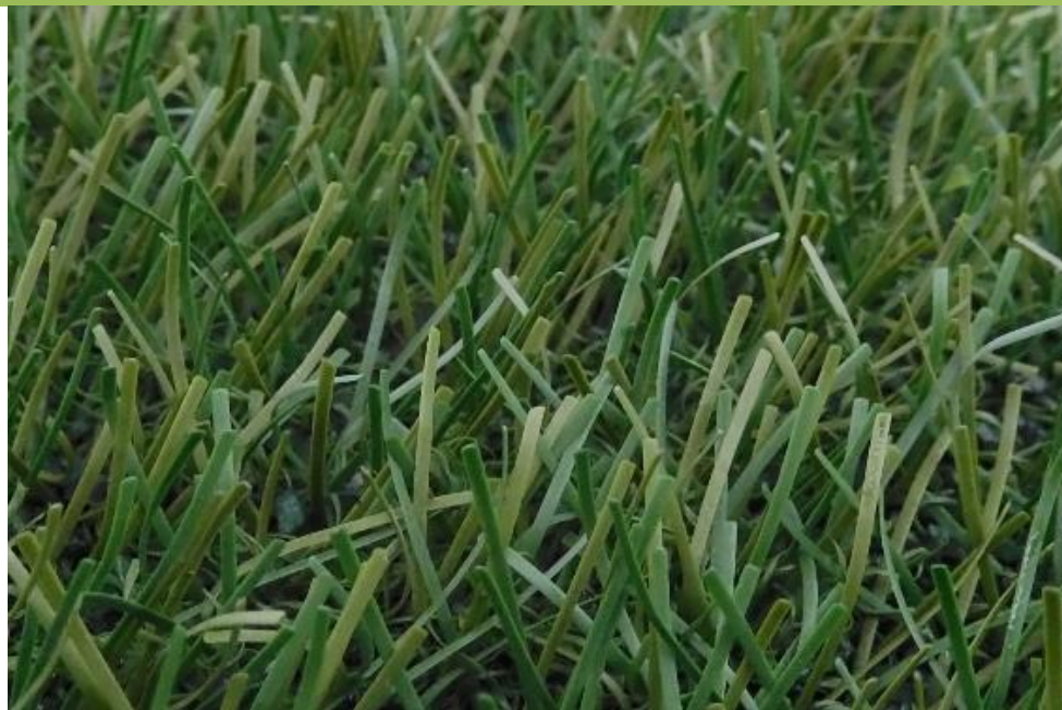
Fig. 14: FieldTurf RGF XM7 después de 120.000 ciclos Lisport
