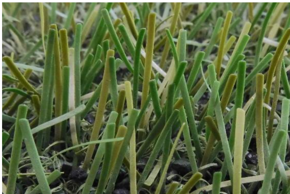
Fig. 35: FieldTurf RGF XM7 después de 320.000 ciclos Lisport
