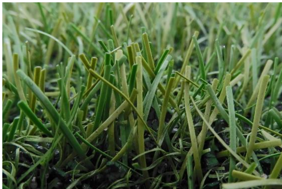
Fig. 15: FieldTurf RGF XM7 después de 120.000 ciclos Lisport
