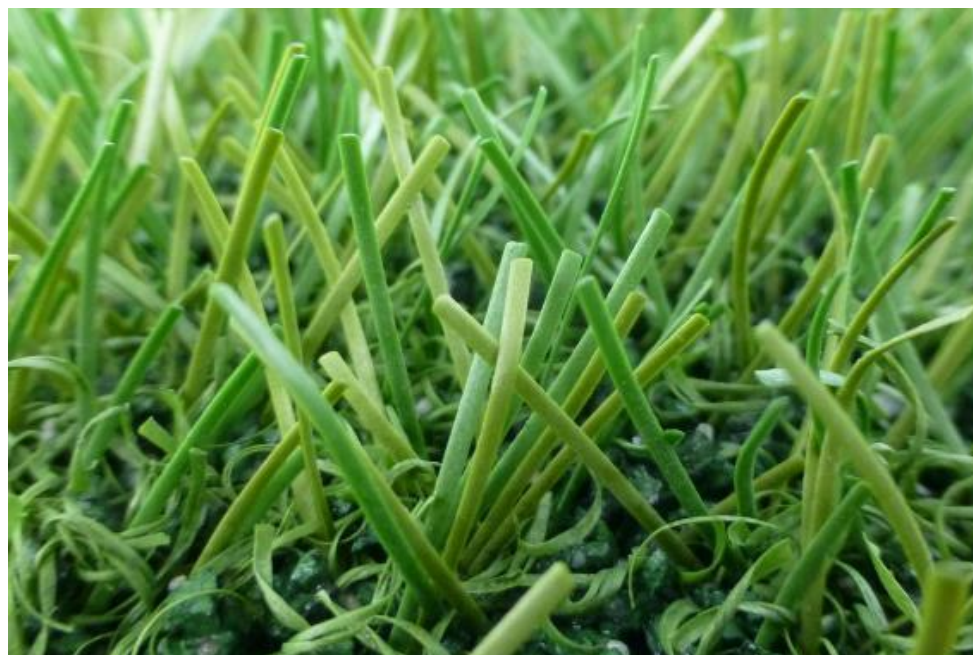
Fig. 10: FieldTurf RGF XM7 después de 80.000 ciclos Lisport
