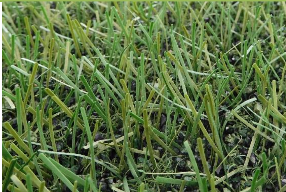
Fig. 34: FieldTurf RGF XM7 después de 320.000 ciclos Lisport
