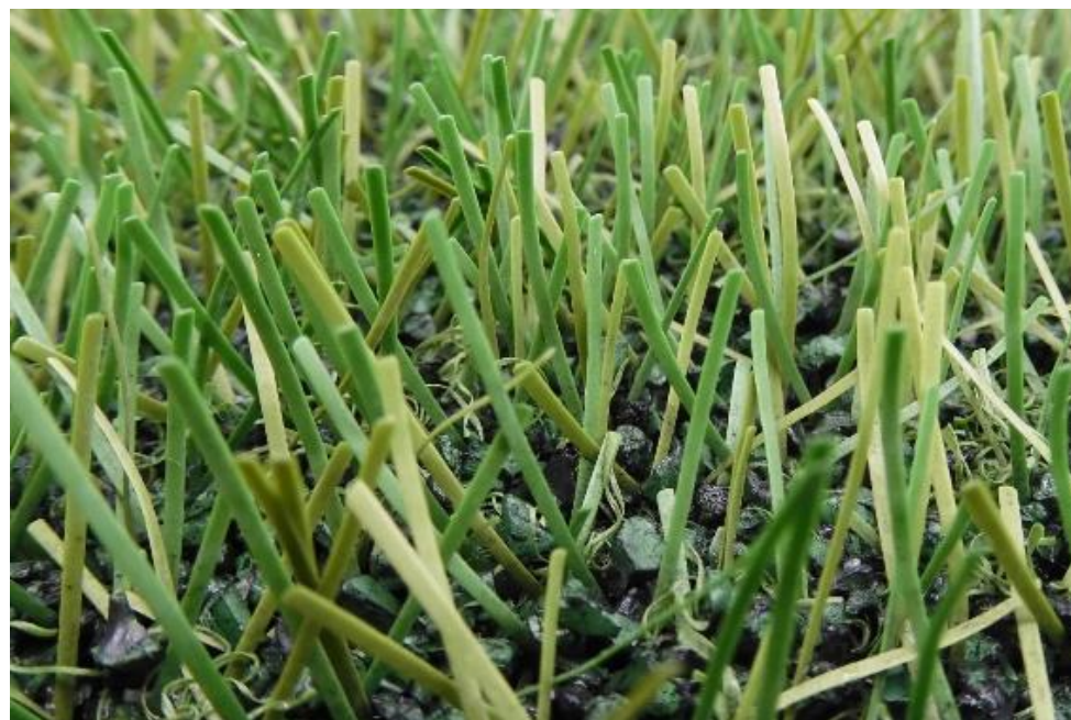
Fig. 25: FieldTurf RGF XM7 después de 220.000 ciclos Lisport
