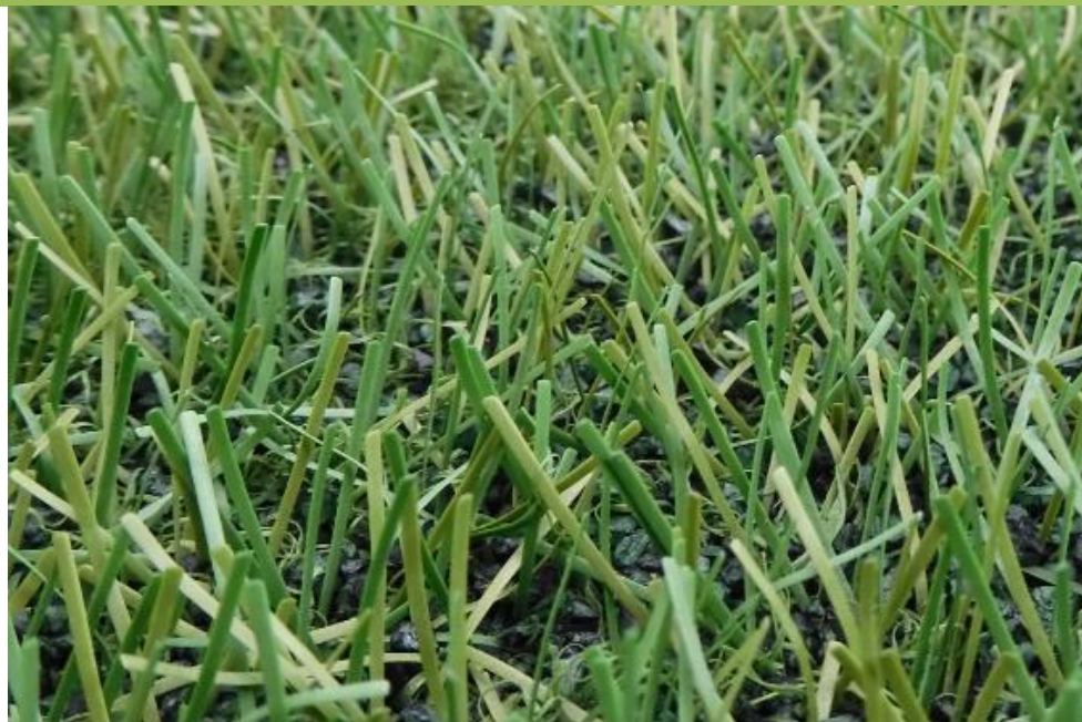
Fig. 24: FieldTurf RGF XM7 después de 220.000 ciclos Lisport
