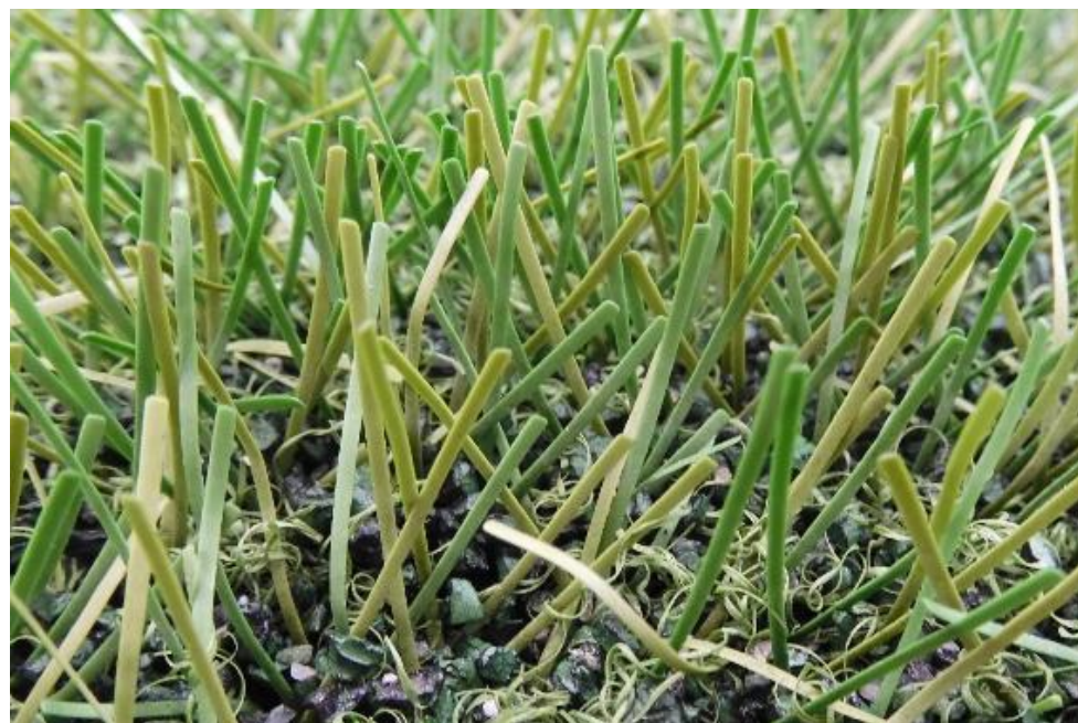
Fig. 31: FieldTurf RGF XM7 después de 280.000 ciclos Lisport
