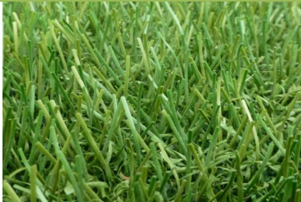
Fig. 6: FieldTurf RGF XM7 después de 40.000 ciclos Lisport
