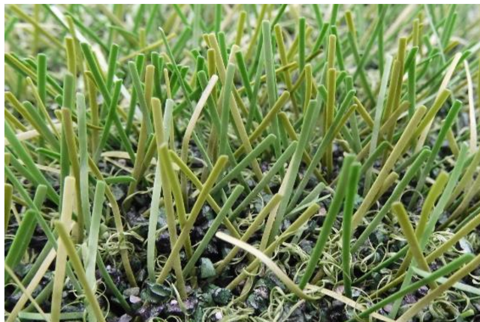
Fig. 31: FieldTurf RGF XM7 después de 280.000 ciclos Lisport
