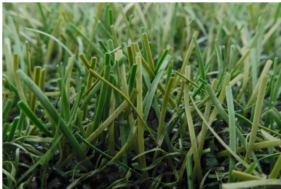
Fig. 15: FieldTurf RGF XM7 después de 120.000 ciclos Lisport
