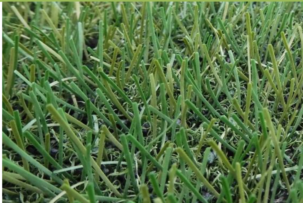
Fig. 30: FieldTurf RGF XM7 después de 280.000 ciclos Lisport
