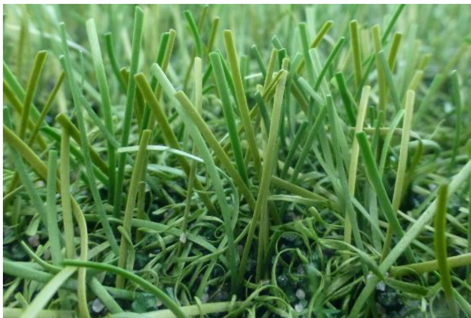
Fig. 19: FieldTurf RGF XM7 después de 140.000 ciclos Lisport
