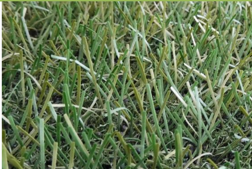
Fig. 36: FieldTurf RGF XM7 después de 340.000 ciclos Lisport
