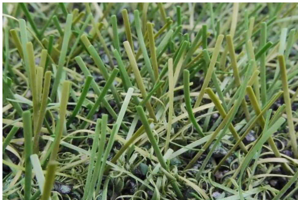
Fig. 27: FieldTurf RGF XM7 después de 240.000 ciclos Lisport
