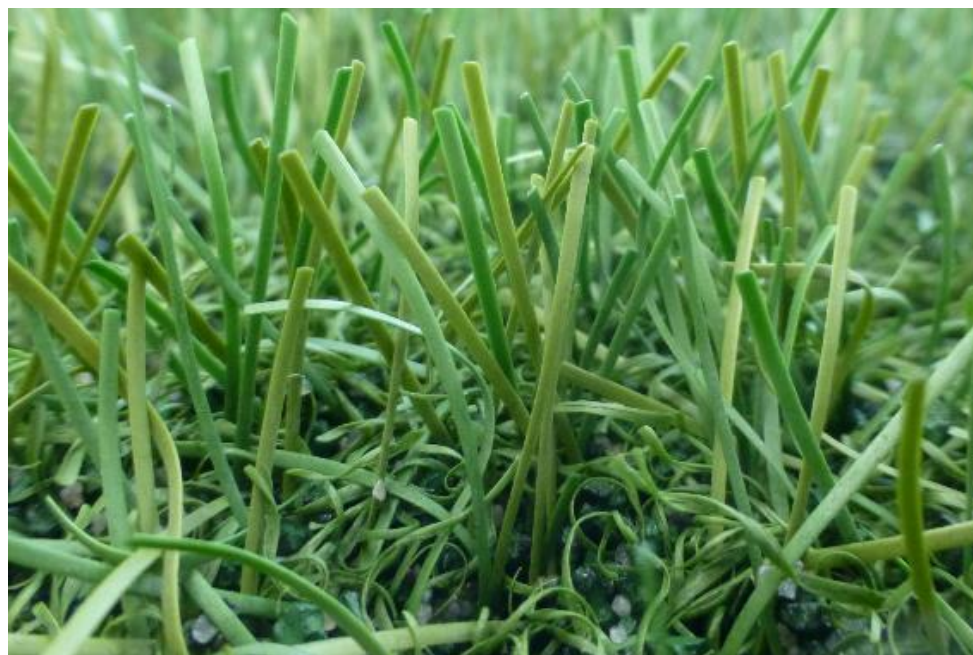
Fig. 19: FieldTurf RGF XM7 después de 140.000 ciclos Lisport
