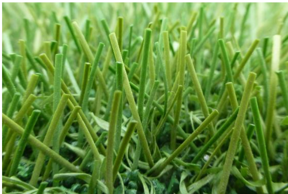
Fig. 5: FieldTurf RGF XM7 después de 20.000 ciclos Lisport
