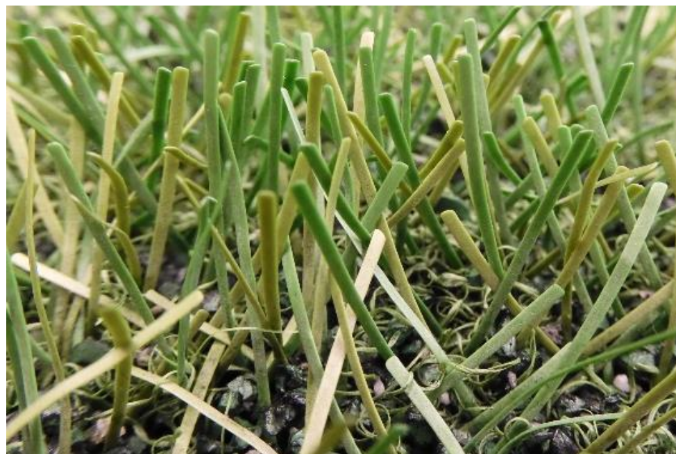
Fig. 36: FieldTurf RGF XM7 después de 300.000 ciclos Lisport
