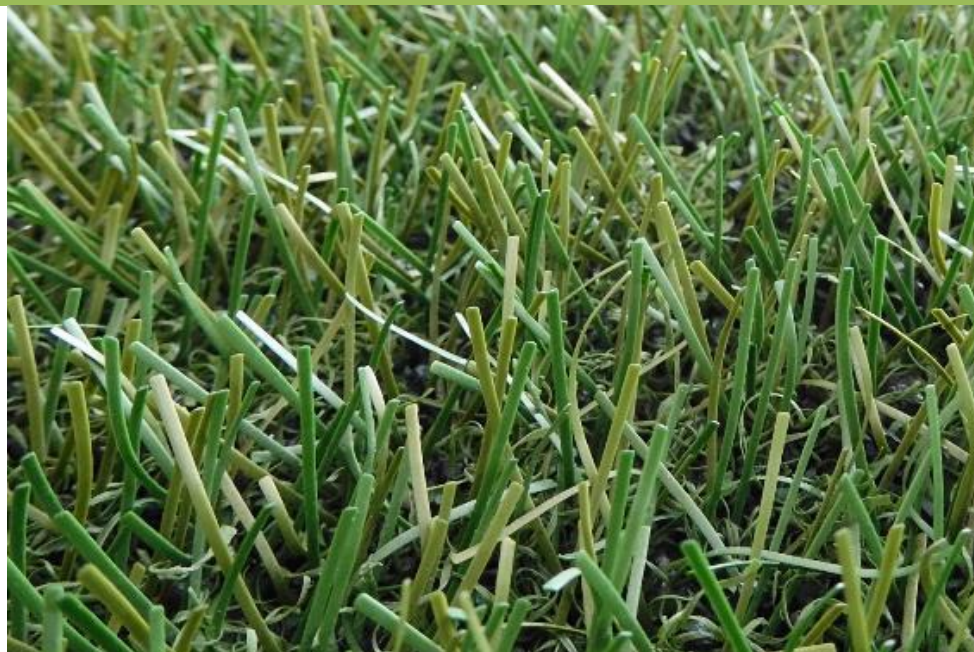
Fig. 18: FieldTurf RGF XM7 después de 160.000 ciclos Lisport
