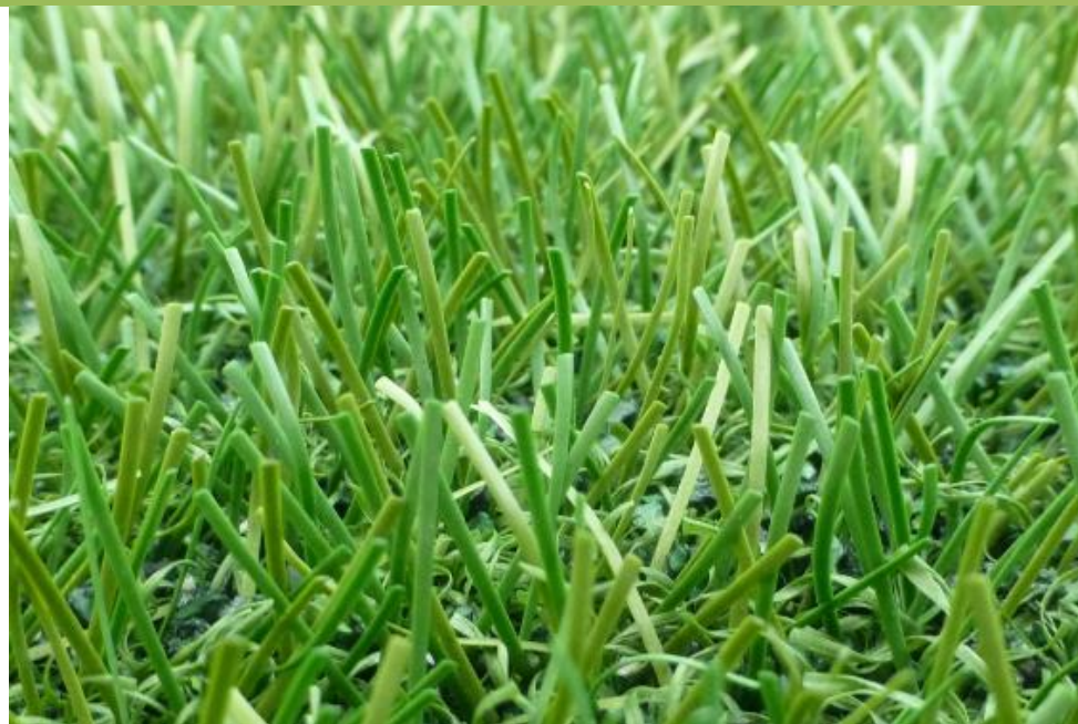
Fig. 10: FieldTurf RGF XM7 después de 80.000 ciclos Lisport
