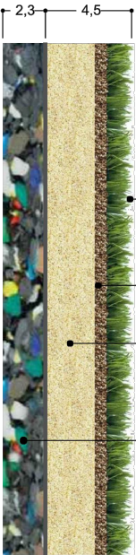
PERFIL CONSTRUCTIU SISTEMA DE GESPA ARTIFICIAL
