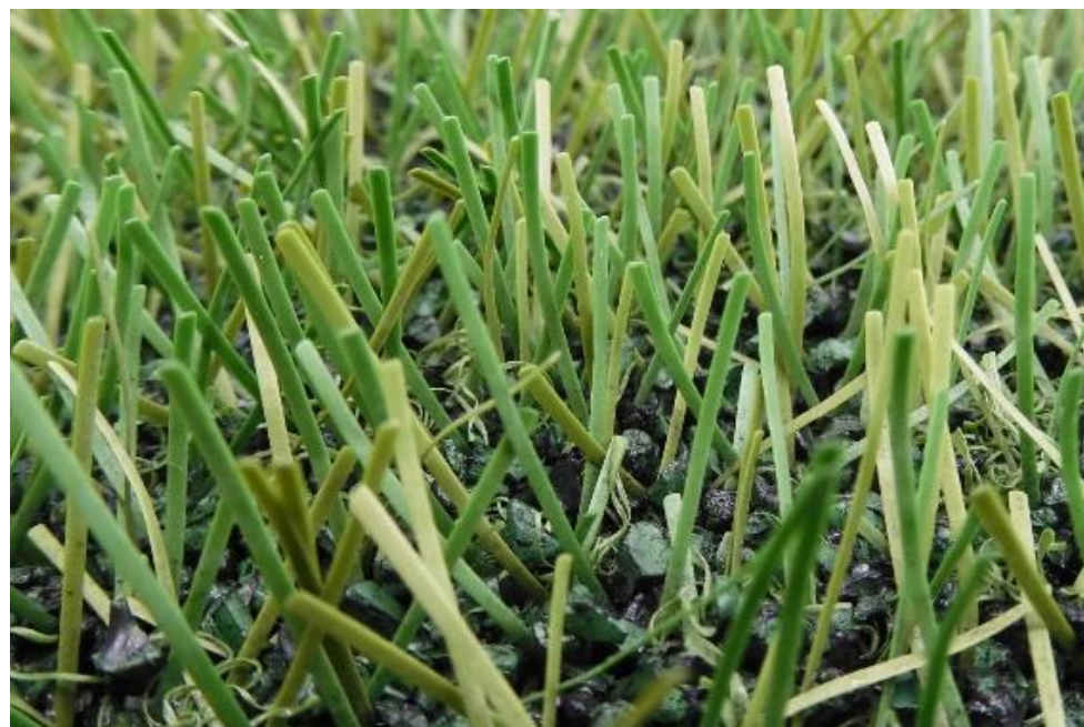
Fig. 25: FieldTurf RGF XM7 después de 220.000 ciclos Lisport
