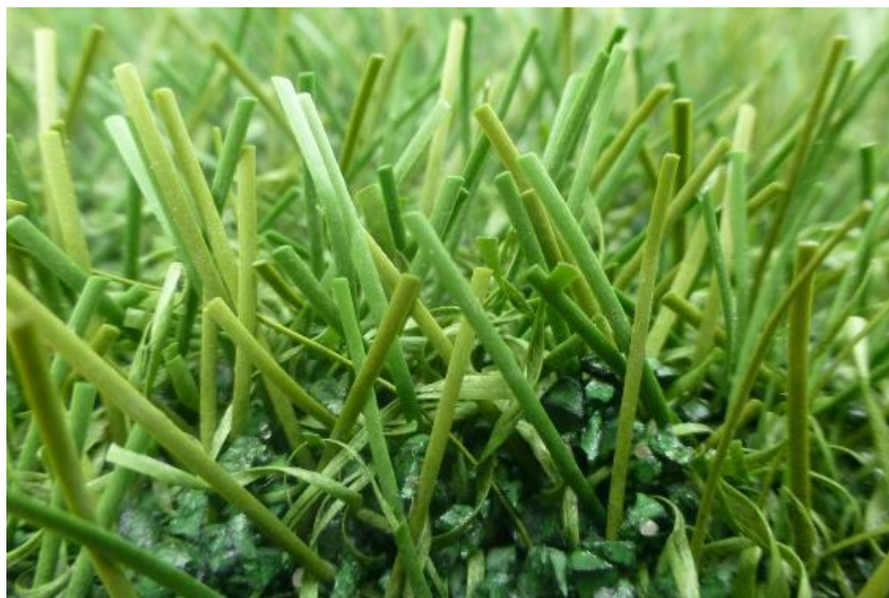
Fig. 7: FieldTurf RGF XM7 después de 40.000 Ciclos Lisport
