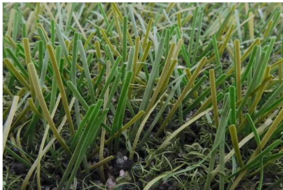
Fig. 41: FieldTurf RGF XM7 después de 350.000 ciclos Lisport
