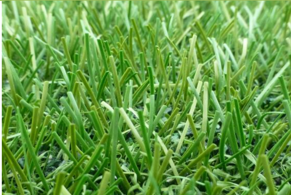
Fig. 10: FieldTurf RGF XM7 después de 80.000 ciclos Lisport
