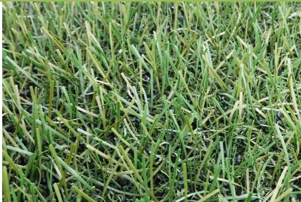
Fig. 28: FieldTurf RGF XM7 después de 260.000 ciclos Lisport
