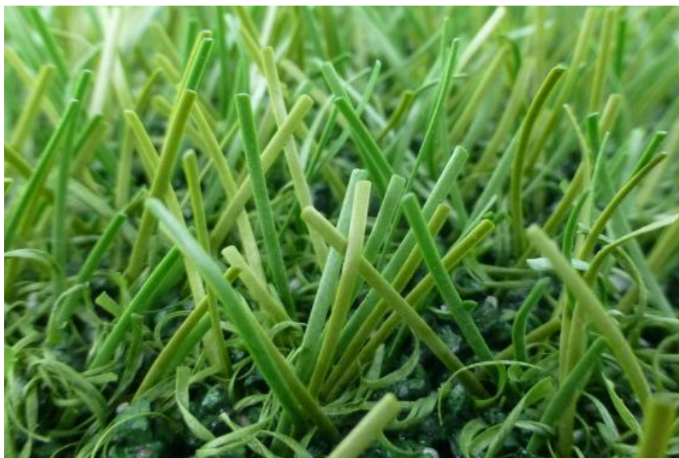
Fig. 10: FieldTurf RGF XM7 después de 80.000 ciclos Lisport
