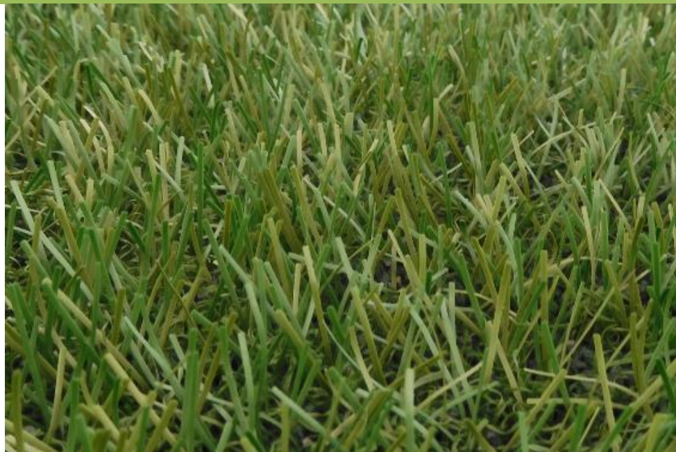
Fig. 12: FieldTurf RGF XM7 después de 100.000 ciclos Lisport
