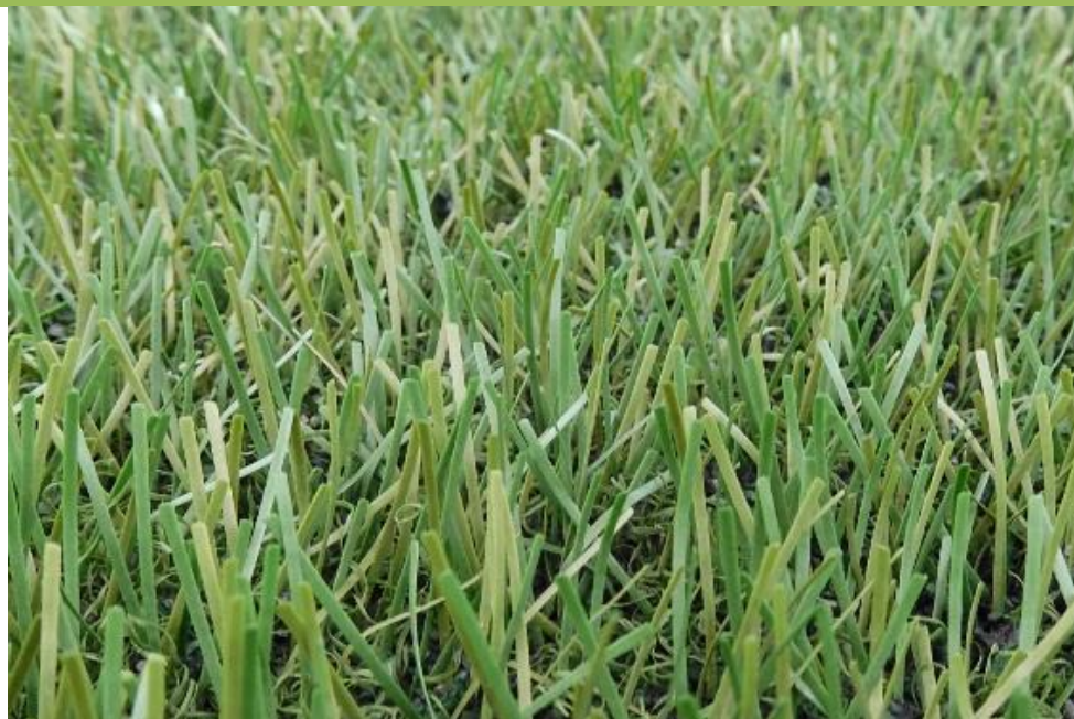
Fig. 20: FieldTurf RGF XM7 después de 180.000 ciclos Lisport
