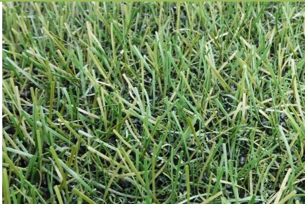
Fig. 28: FieldTurf RGF XM7 después de 260.000 ciclos Lisport
