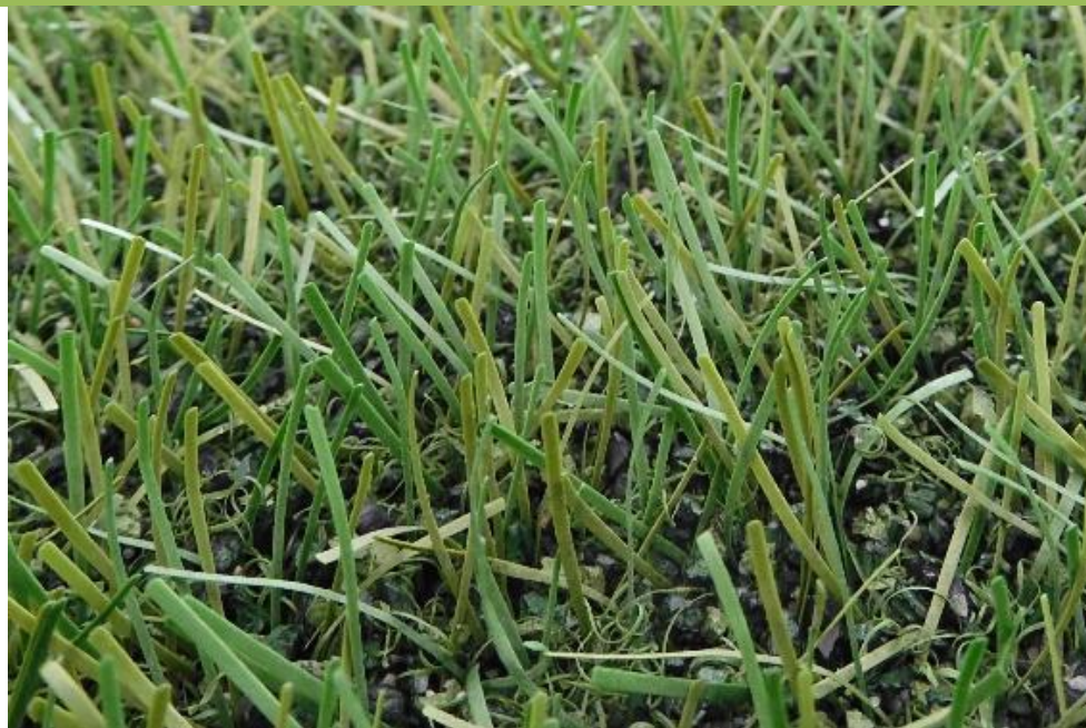
Fig. 34: FieldTurf RGF XM7 después de 320.000 ciclos Lisport
