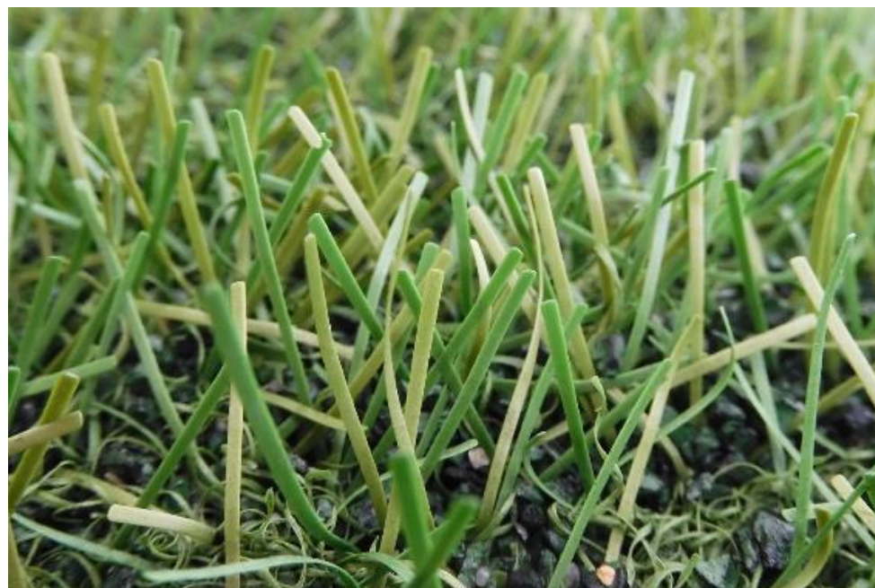
Fig. 29: FieldTurf RGF XM7 después de 260.000 ciclos Lisport
