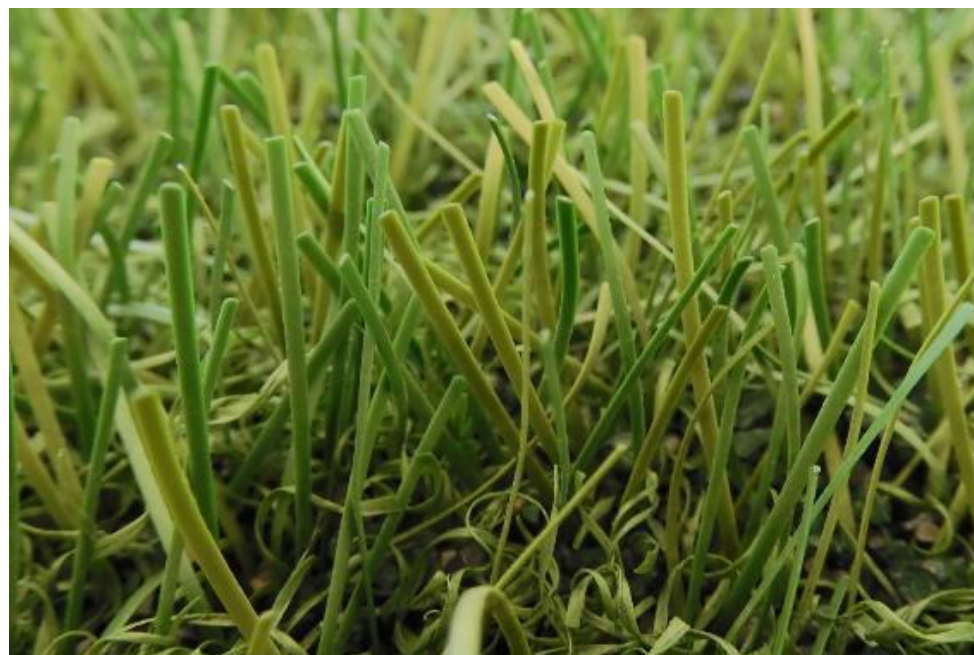
Fig. 13: FieldTurf RGF XM7 después de 100.000 ciclos Lisport
