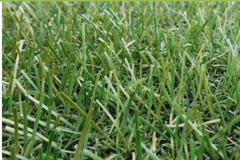
Fig. 22: FieldTurf RGF XM7 después de 200.000 ciclos Lisport
