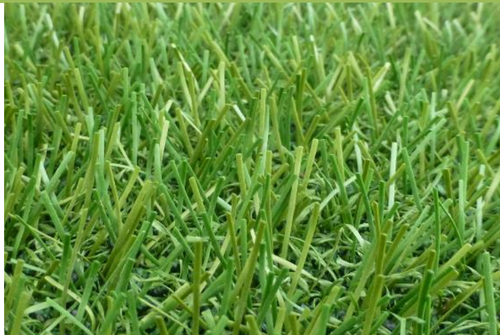
Fig. 8: FieldTurf RGF XM7 después de 60.000 ciclos Lisport
