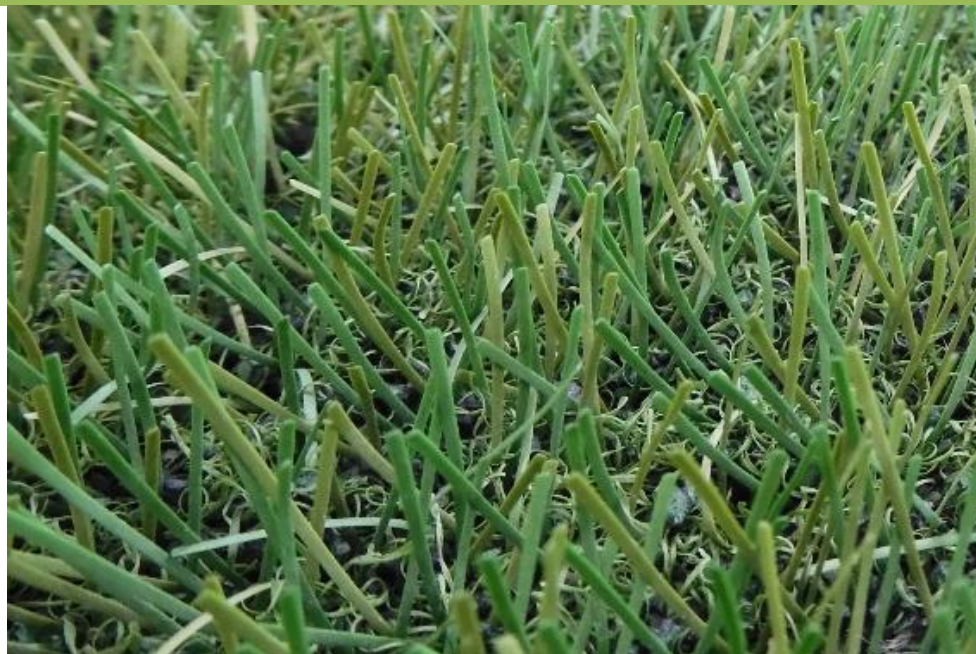
Fig. 30: FieldTurf RGF XM7 después de 280.000 ciclos Lisport
