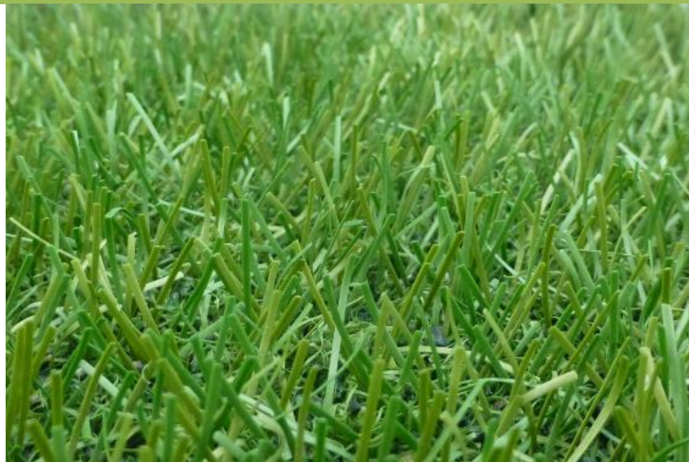
Fig. 18: FieldTurf RGF XM7 después de 140.000 ciclos Lisport
