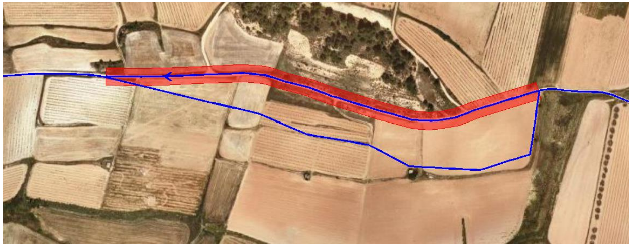
Imatge 29: Tram del col·lector per gravetat que caldria col·locar per fora el camí degut a l'existència del tossal, que fa que la rasant del camí sigui ascendent.
