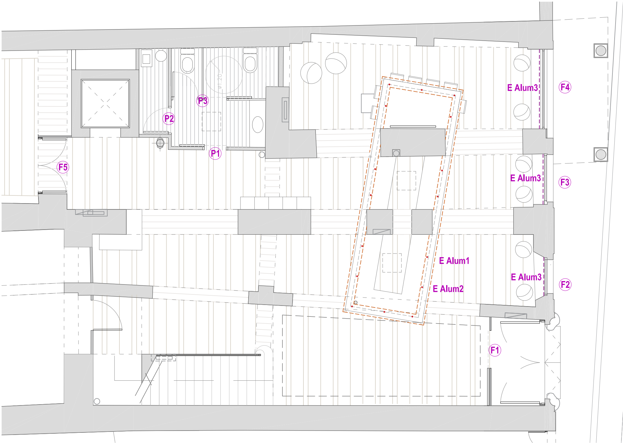
PLANTA BAIXA ACCÉS - FUSTERIES EXTERIORS esc. 1/75
