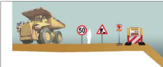
Esquema protecció i senyalització de desmunt i terraplens
