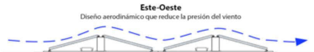
Imatge 7. Afectació del vent a estructura bi-orientada.
