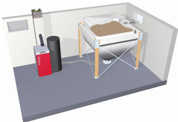
Figura 12. Instal·lació de biomassa domèstica amb sitja tèxtil. Aquesta és equivalent a una sitja amb quatre pendents, en què el pèl·let es recull en un col·lector a la seva base des d'on s'alimenta la tremuja adjunta a la caldera mitjançant un sistema pneumàtic.
