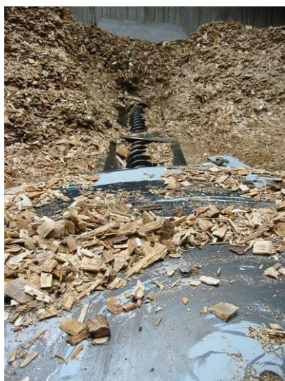
Figura 10. El vis sens fi obert admet l'alimentació de biocombustible en tota la seva longitud.
