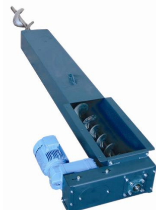
Figura 9. El vis sens fi tancat disposa d'un espai obert a la carcassa per on entra el biocombustible. La resta del recorregut està protegit d'agents externs.
