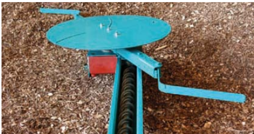
Sistema d'alimentació rotatiu mitjançant braços articulats amb vis-sens-fi proposat
