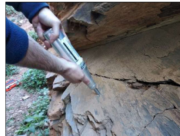
Assaig amb martell de Schmidt (escleròmetre).
