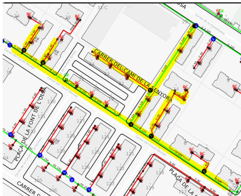
Il·lustració 4: Canonades a substituir per l'obra definitiva.
