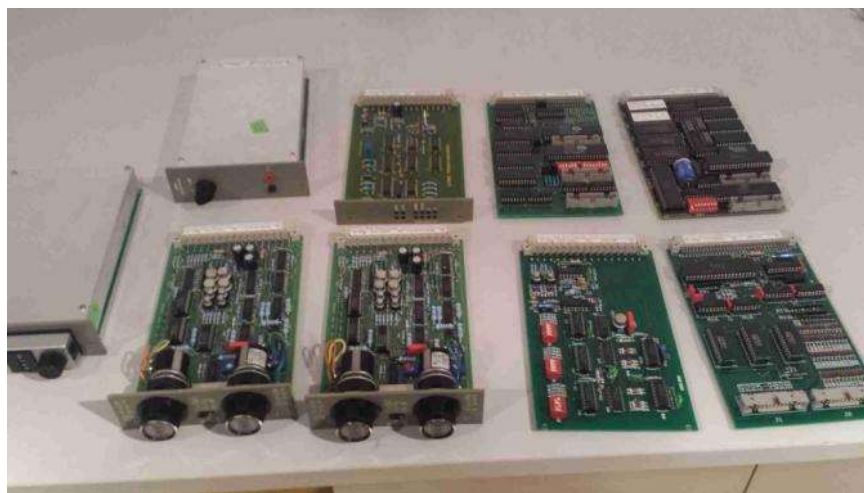
Detall d'algunes de les plaques electròniques que formen el sistema de mesura
