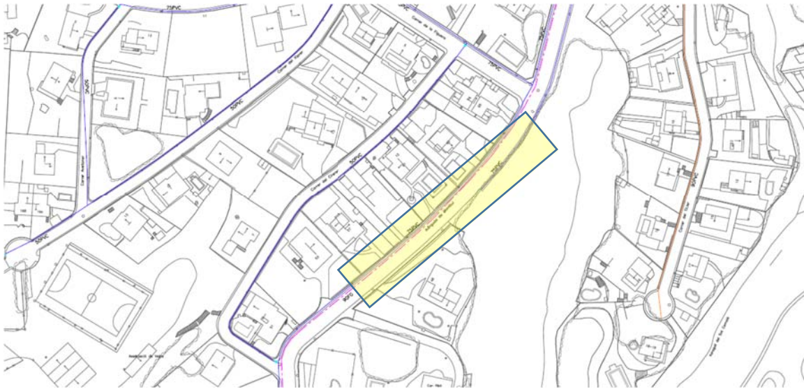
Figura 2. Plànol xarxa aigua potable a l'Av. Montbui 48-50
