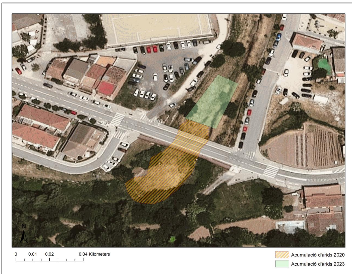
Il·lustració 4. Descripció del moviment de sediments i la localització actual del material a retirar. Elaboració pròpia.
