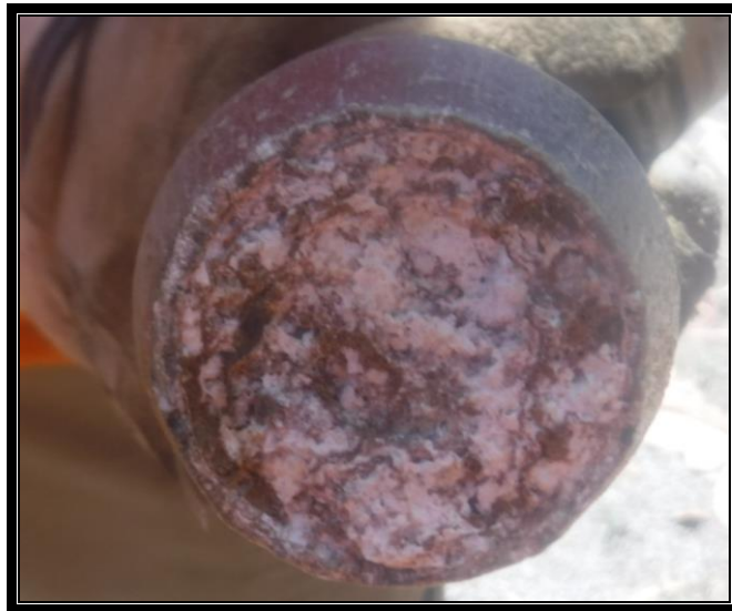
Detall dels materials de la capa B, recuperats a un assaig SPT.
