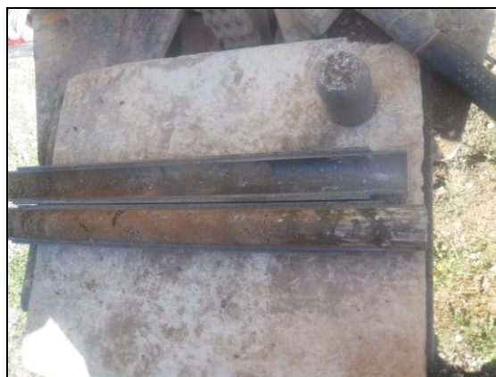
Foto 2: Sondeig S-1, SPT a 1,1 metres.
