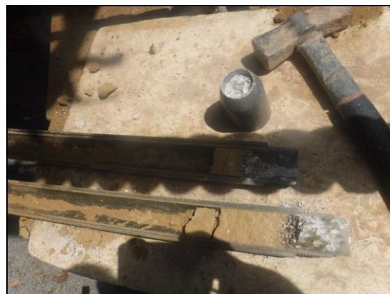
Foto 8: Sondeig S-2, SPT a 8,6 metres.
