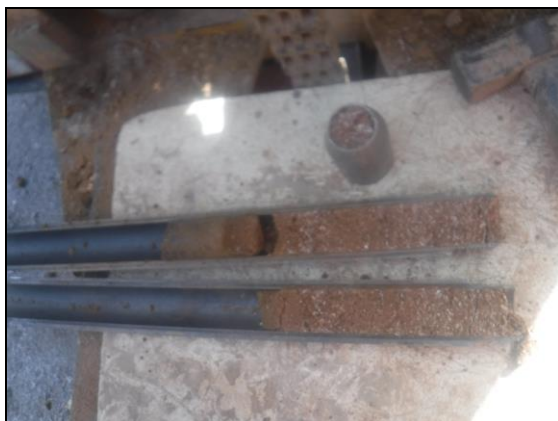
Foto 13: Sondage S-3, SPT a 14,4 metres.
