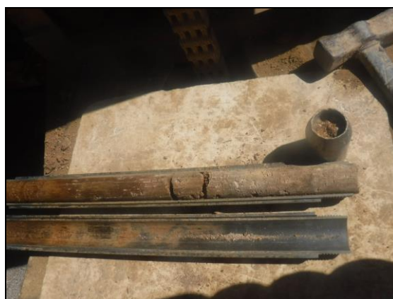
Foto 6: Sondeig S-2, SPT a 3,4 metres.
