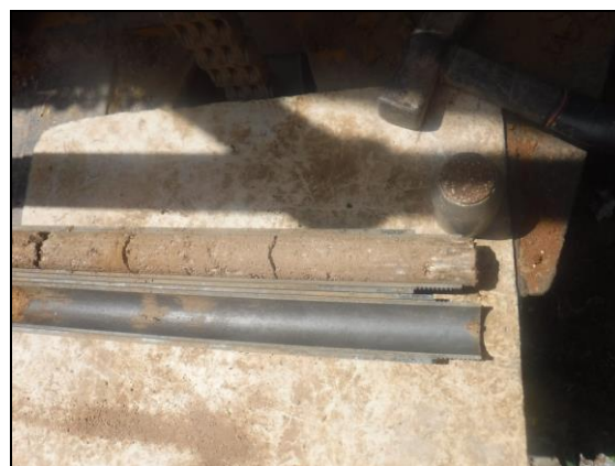
Foto 10: Sondeig S-3, SPT a 1,6 metres.
