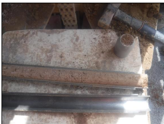
Foto 15: Sondage S-4, SPT a 1,1 metres.
