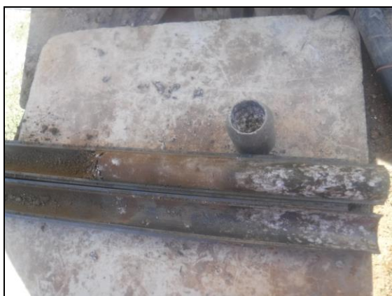
Foto 3: Sondeig S-1, SPT a 3,3 metres.
