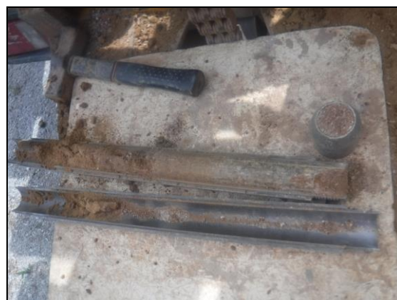
Foto 12: Sondeig S-3, SPT a 7,2 metres.
