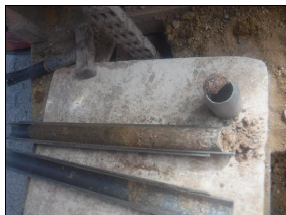
Foto 18: Sondage S-4, SPT a 9,4 metres.
