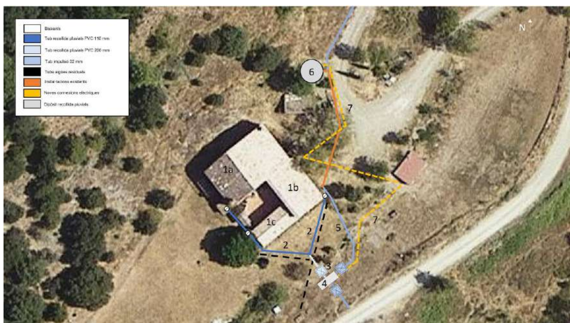
Figura núm. 4: Esquema de la recollida i emmagatzemament de l'aigua a la Casa Nova de Sant Miquel. Font: Elaboració pròpia
