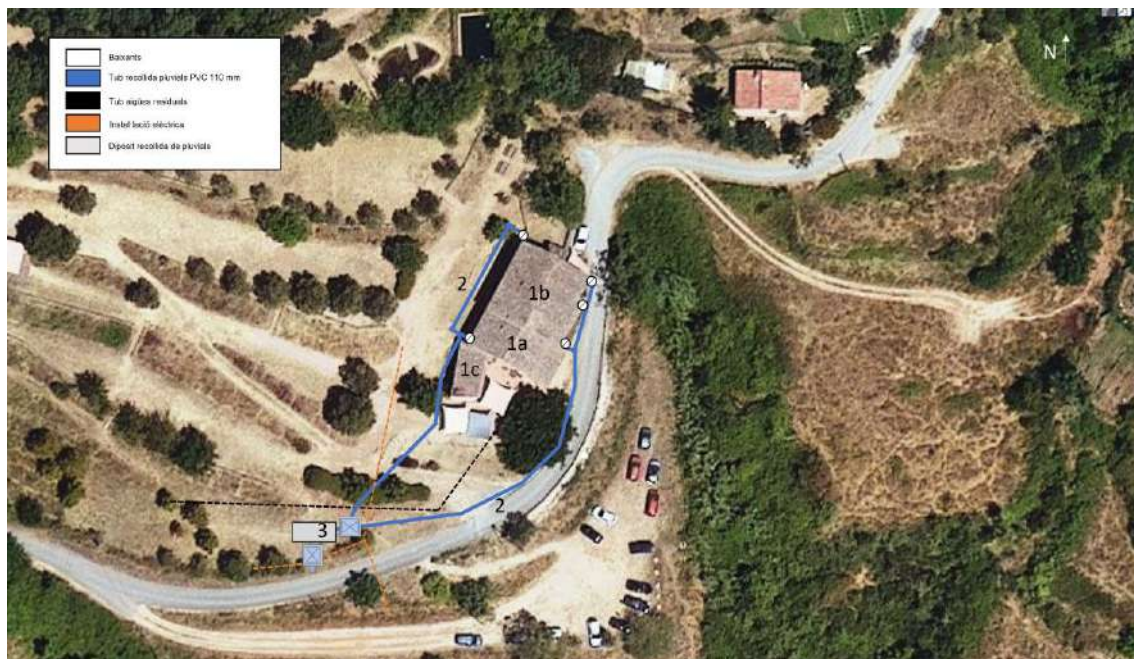
Figura núm. 6: Esquema de la recollida i emmagatzemament de l'aigua a la Rectoria de Vallcàrquera. Font: Elaboració pròpia
