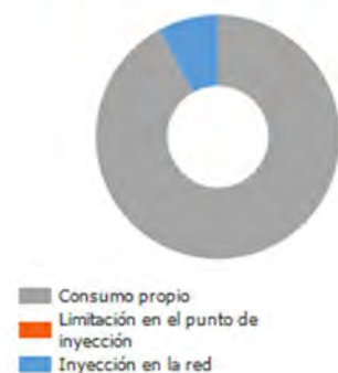
Energía de generador FV (Red CA)
