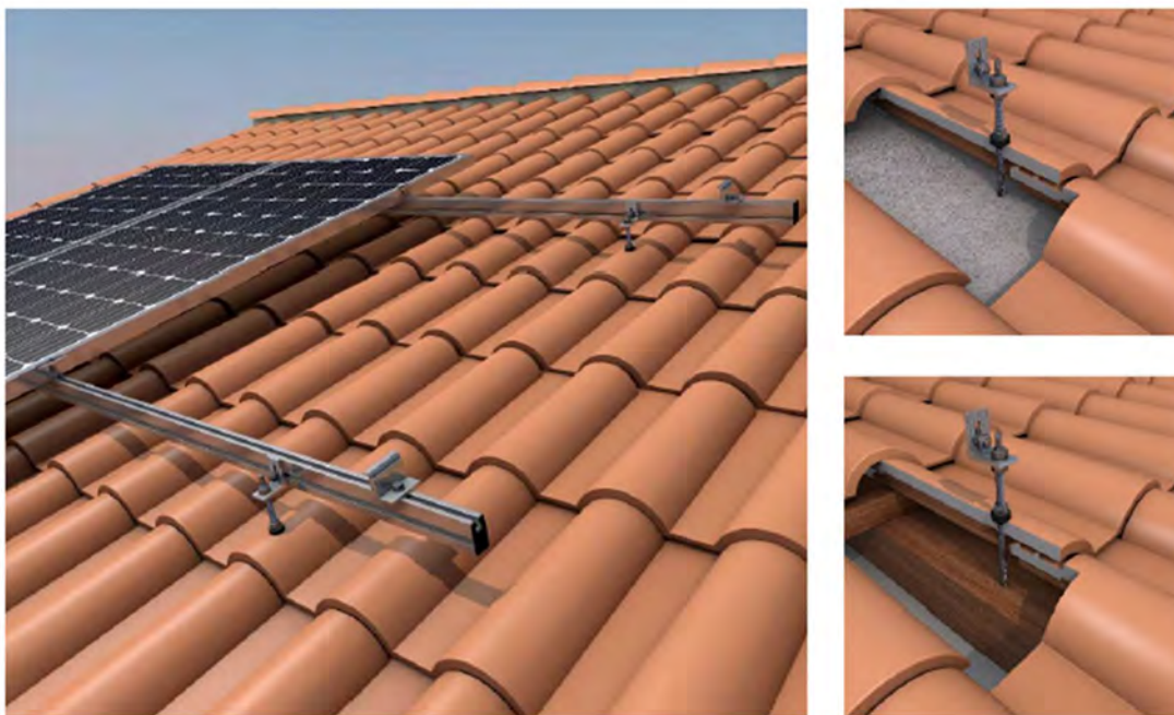
Figure 10 - Imagen del sistema de fijación seleccionado
