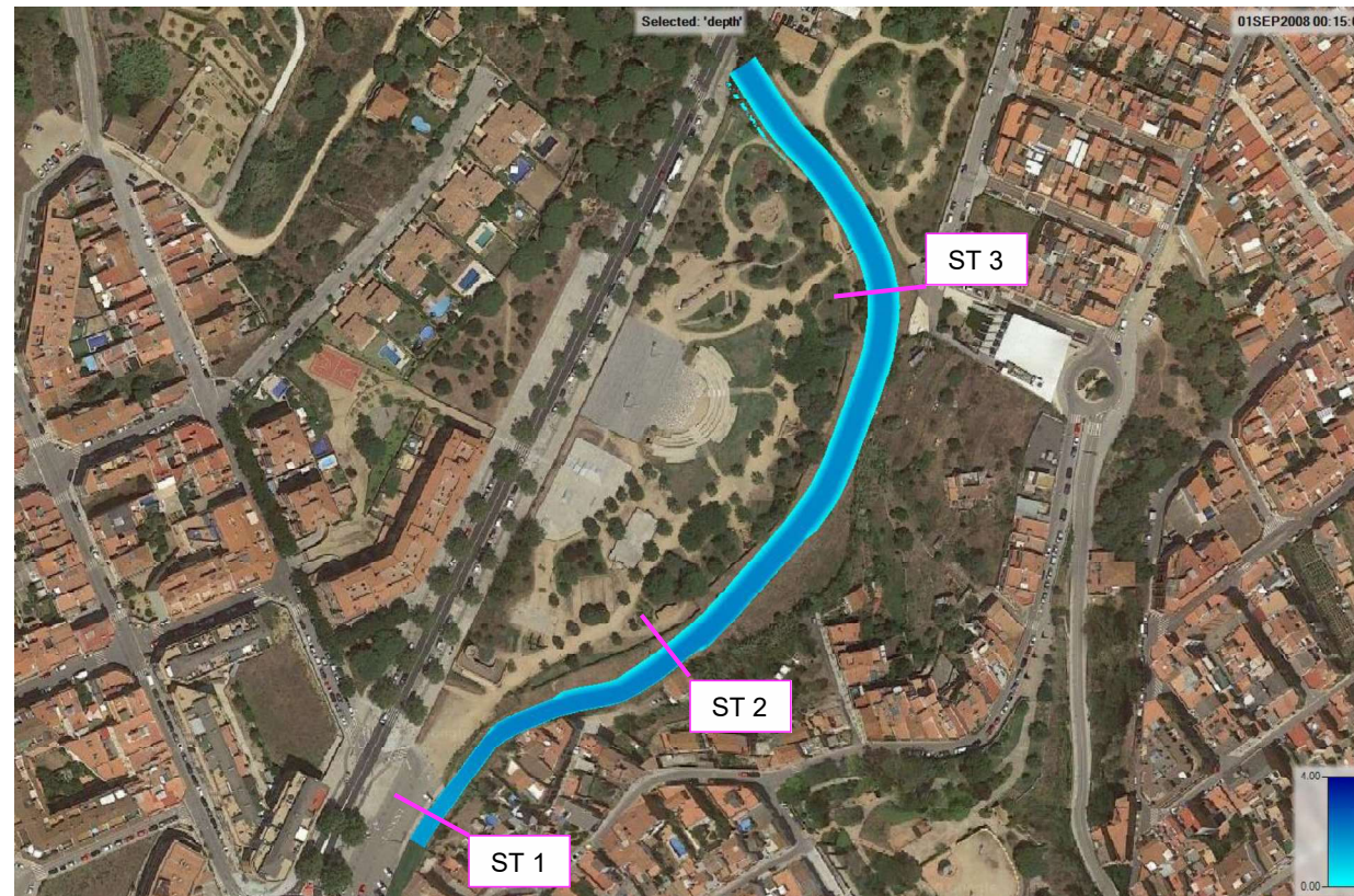
Figura 10. Inundació associada a 61 \text{ m}^3/\text{s} en l'endegament
