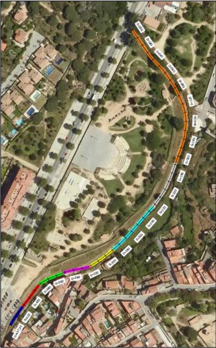
Figura 7. Planta de tramificació de seccions de l'endegament.
