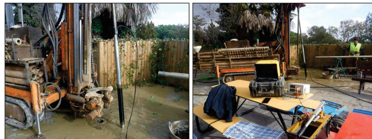
Detall d'un dels assaigs pressiomètrics realitzats al sondeig S-1.
