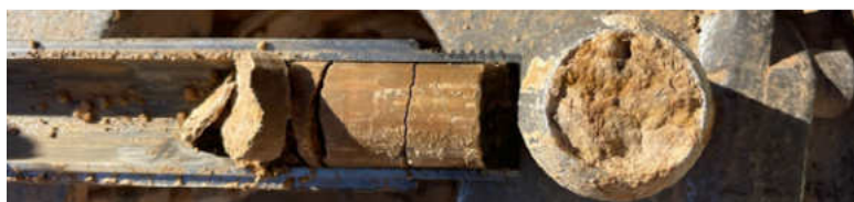
Fotografies 5 i 6. Sondeig S2 a dalt i mostra tipus SPT a 3m.
