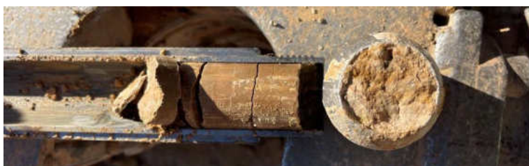
Fotografies 1, 2, 3 i 4. Sondeig S1 a dalt i mostres dels assaigs SPT realitzats a les profunditats de 1m, 2,5m i 6m.
