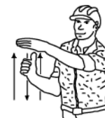
4 Levantar el aguilón o pluma lentamente.
