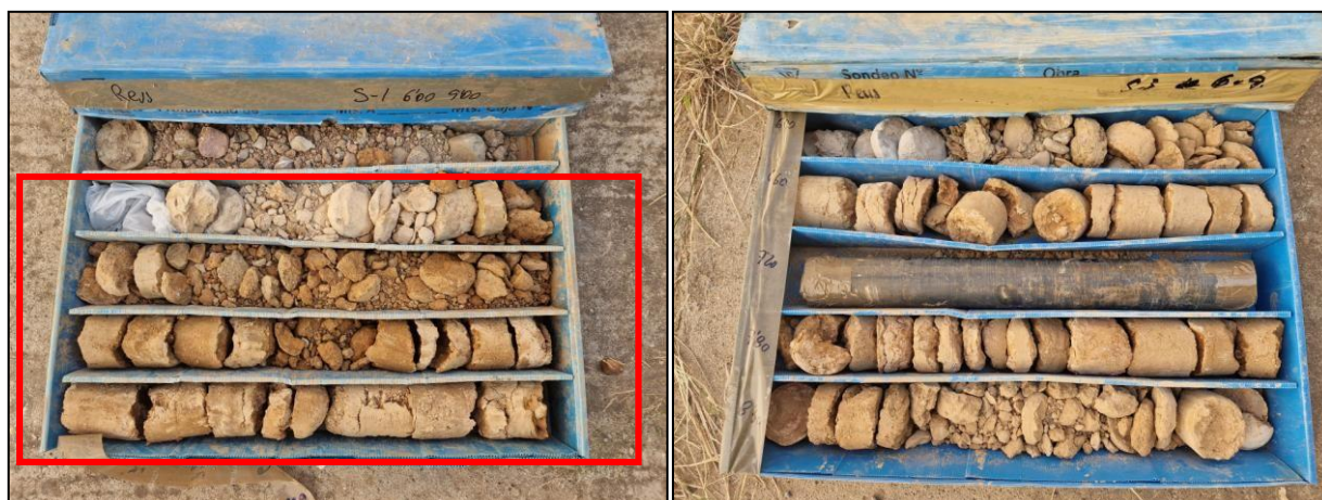
Nivell B en el sondeig S-1 (esquerra) i en el sondeig S-3 (dreta) amb el nivell carbonatat a sostre
