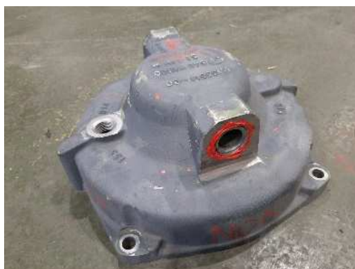
Cos del cilindre de fre a reparar
