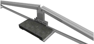
Los portalastres internos siempre se dirigen hacia el interior, dejando el lastre oculto bajo el módulo.
