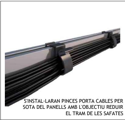
DETALL ESTRUCTURA SUPORTACIÓ PANELLS FOTOVOLTAICS
