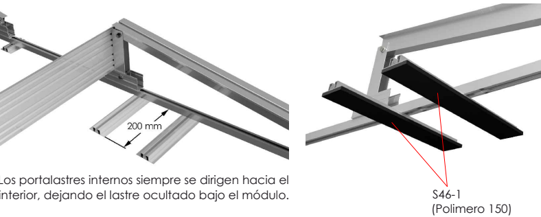
Ejemplo de contrapeso de hasta 400 mm de ancho sobre portalastre . Fácil regulación del portalastre simplemente aflojando un tornillo (Ejemplo de portalastre descentrado). Regulación del portalastre (Ejemplo colocación de portalastre centrado). Ejemplo de instalación de 2 contrapesos de 1 de hasta 200 mm de ancho repartidos sobre portalastre.
