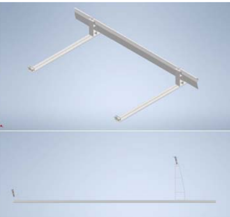
Estructura alumini autoportant 15° amb llast per coberta plana
