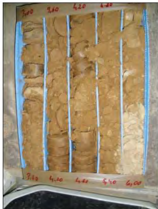
Caixa nº 2: Testimonis extrets del sondeig S-1 compresos entre 3,00 - 6,00 m de profunditat.
