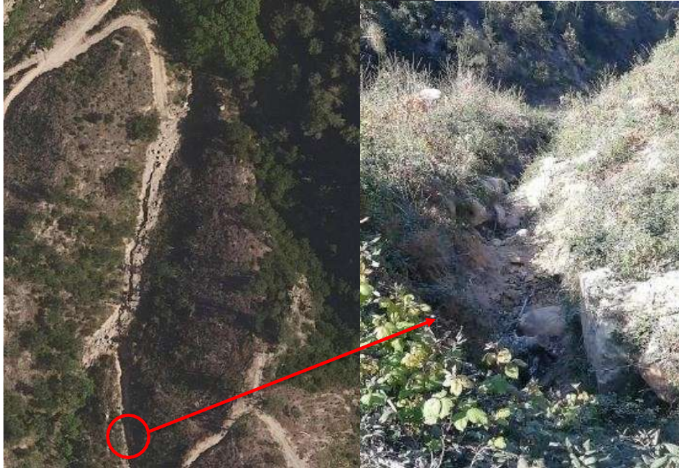
Figura 9. (Esquerra) Xarxa fluvial sobredimensionada per la falta de vegetació que controli la generació d'escolament i l'erosivitat del sòl. (Dreta) Imatge d'una la secció sobredimensionada (6-7 m 2 ) d'un torrent amb una conca vessant de solament 13.000 m 2 .
