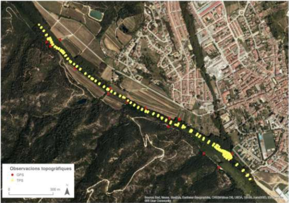
Figura A3. Distribució de les observacions topogràfiques de la llera registrades mitjançant una Estació Total(color groc) i un GPS-RTK (color vermell).
