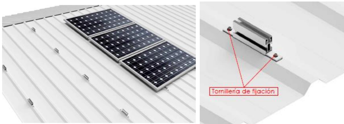
Fig 3. Imatge de la fixació de l'estructura a la coberta de l'edifici
