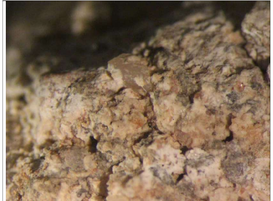
Morter porós, amb poc aglomerant, cristal·litzacions i fissures
