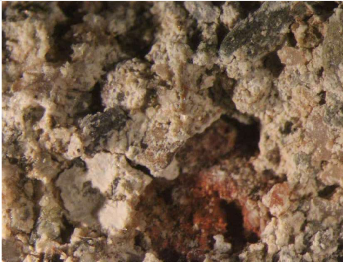
Morter porós, amb poc aglomerant, cristall·litzacions i fessures
