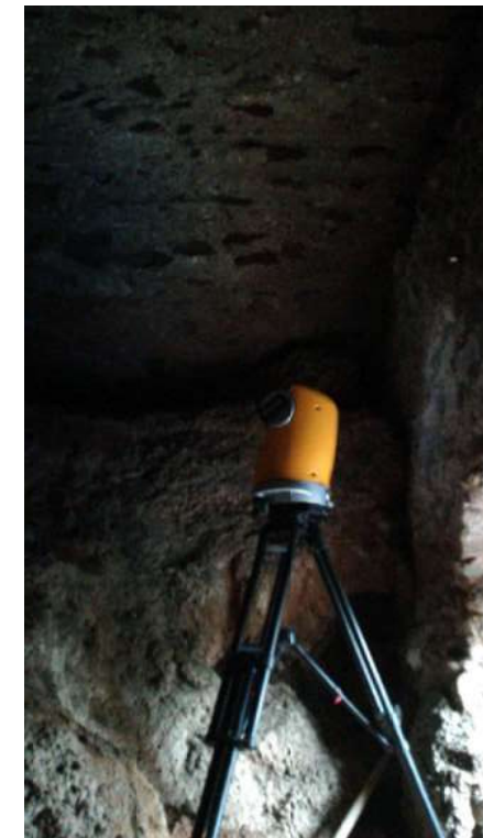
Figura 5: Escàner làser a l'interior de l'arc 4t (14/12/2017)
