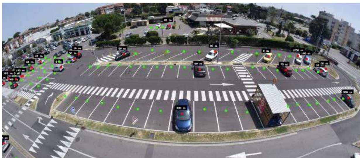
Figura 162 Exemple de detecció de places d'aparcament amb càmera de videovigilància. Font: Parqueo
