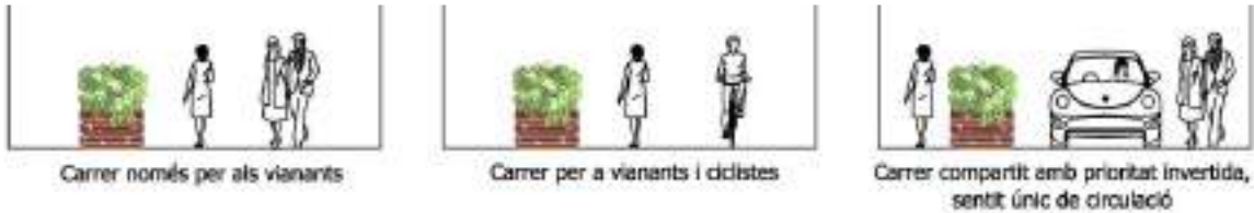
Figura 34 Exemple de secció viària en carrers amb una amplada < 7 m Font: Servei Català de Trànsit
