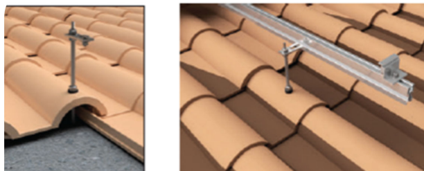
Fig. 7.4. Estructura de subjecció coplanar.
