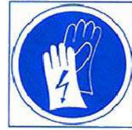
USO GUANTES DIELECTRICOS
