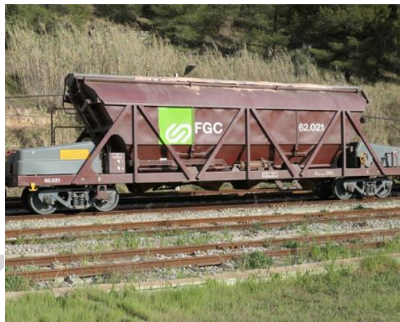
Actualment aquest parc de material mòbil es monitoritza amb un sistema de seguiment i geolocalització GPS que té per objectiu conèixer la posició de cada vagó en temps real, així com analitzar la totalitat dels quilòmetres recorreguts per cada vagó.
